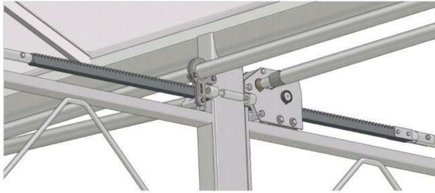
Рис. 3.15. Загальний вид рейкового приводу системи вентиляції в теплиці
