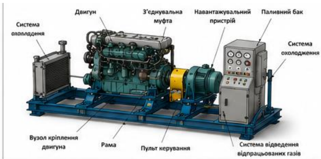
Рисунок 2.1 - Загальна структурна схема керуючої частини двигуно-пускової бази трактора ХТЗ.
