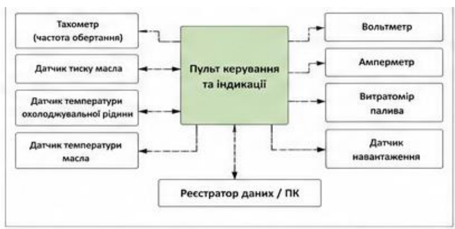
Рисунок 2.10 – Схема системи керування та вимірювання на випробувальному стенді.
