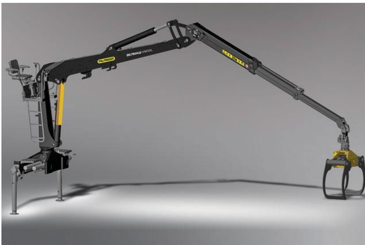
Рис. 1.3. Гідроманіпулятор, який швидко знімається і встановлюється на автомобіль[27]
