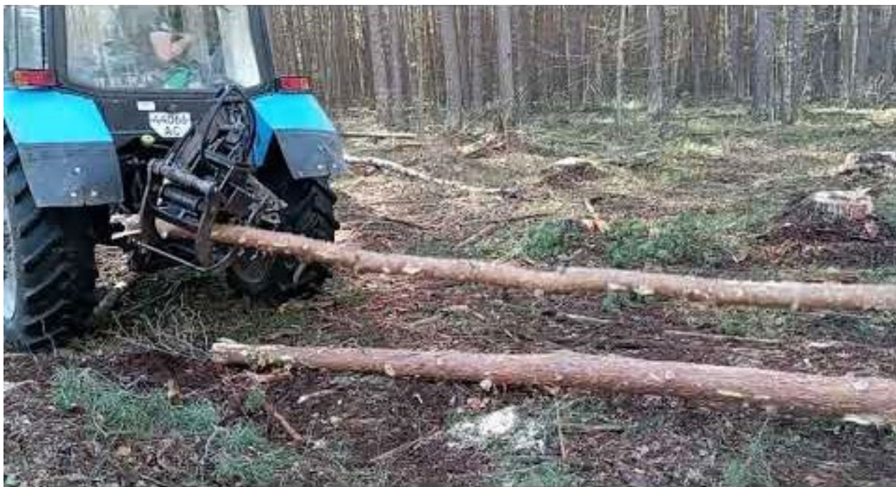
Рис. 4.3. Трелювання деревини трактором МТЗ-82 із гідрозахватом[2]
