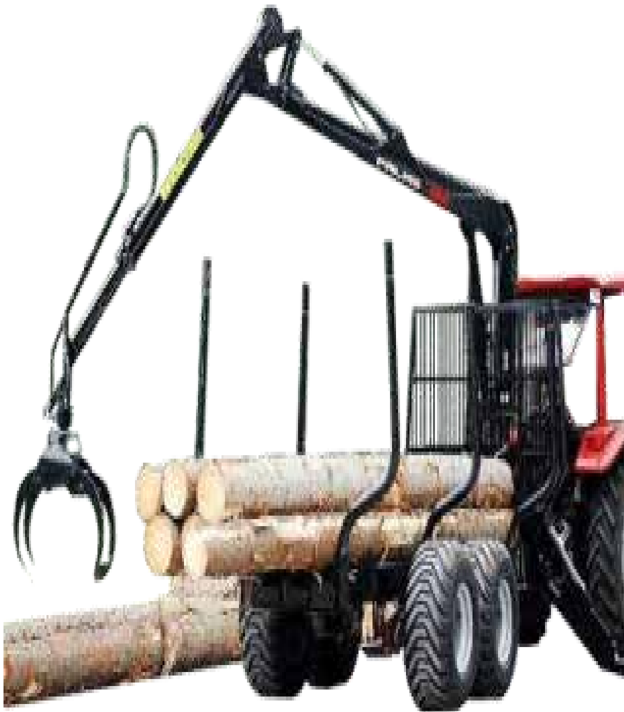
Рис. 4.6. Лісовозний напівпричіп DL-10 в комплектації з гідроманіпулятором Palms [35]
