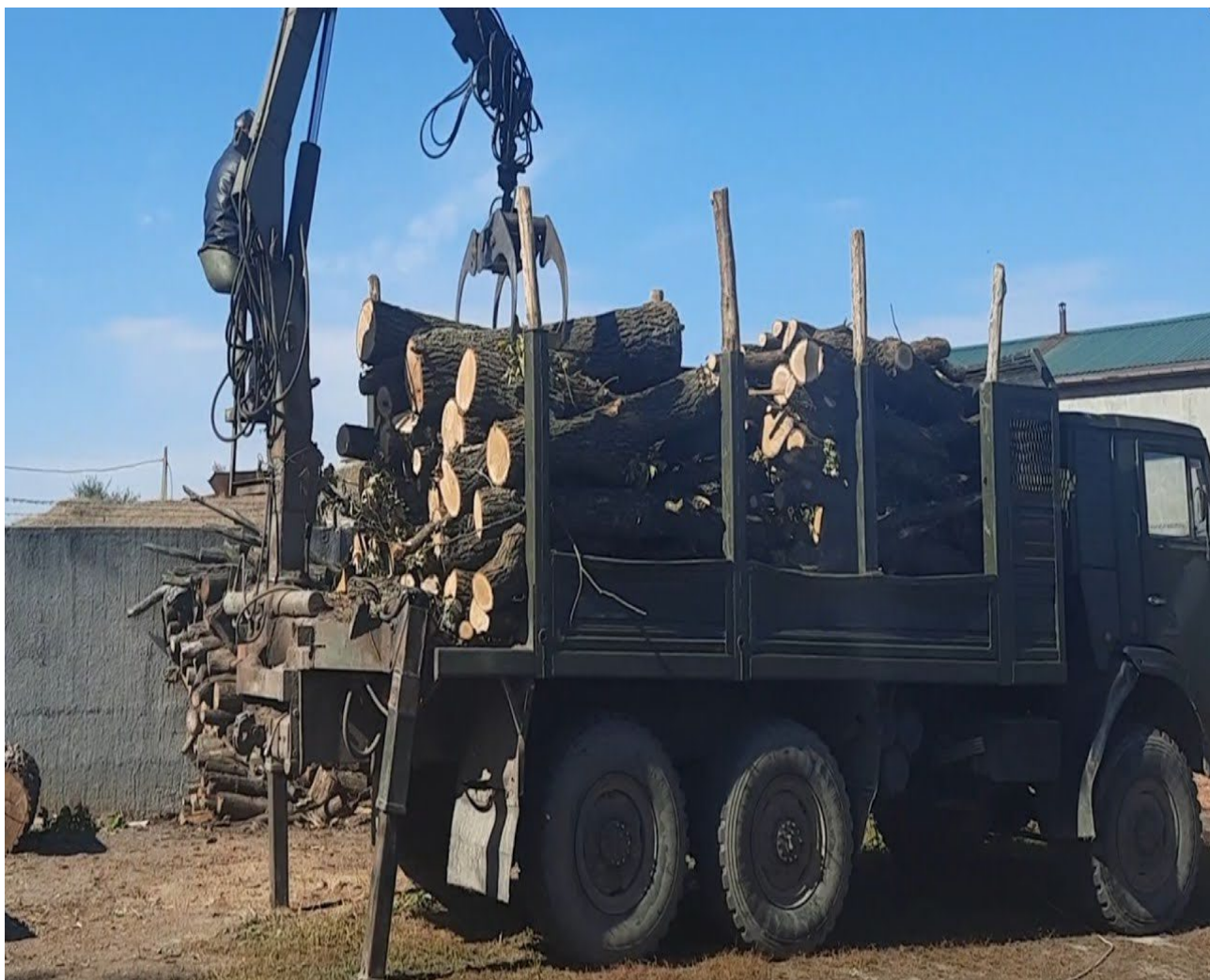
Рис. 4.7. Лісовоз КАМАЗ-4310 з гідроманіпулятором [1]
