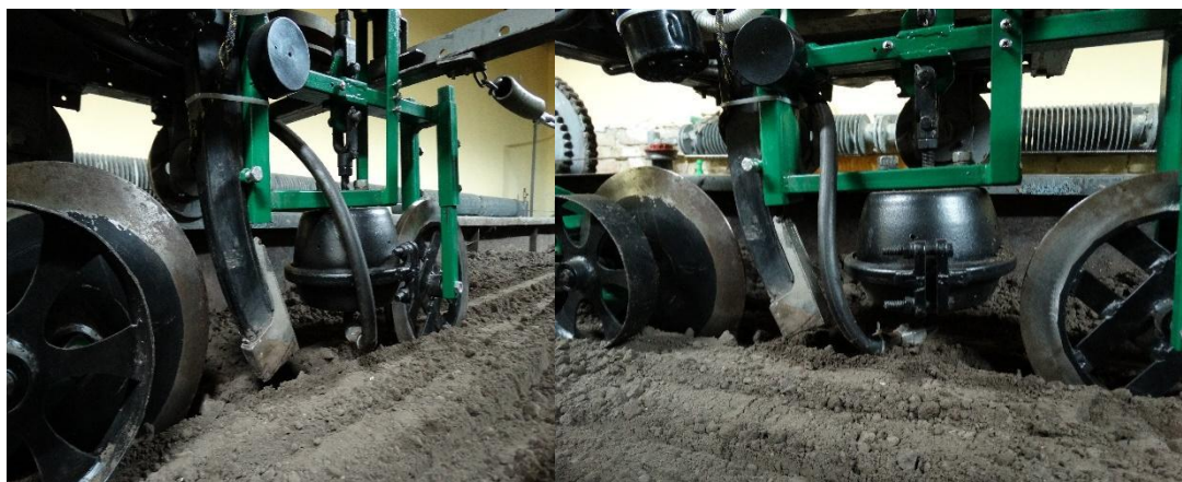
Рис. 3.11 Вигляд сошникової системи під час випробування.
