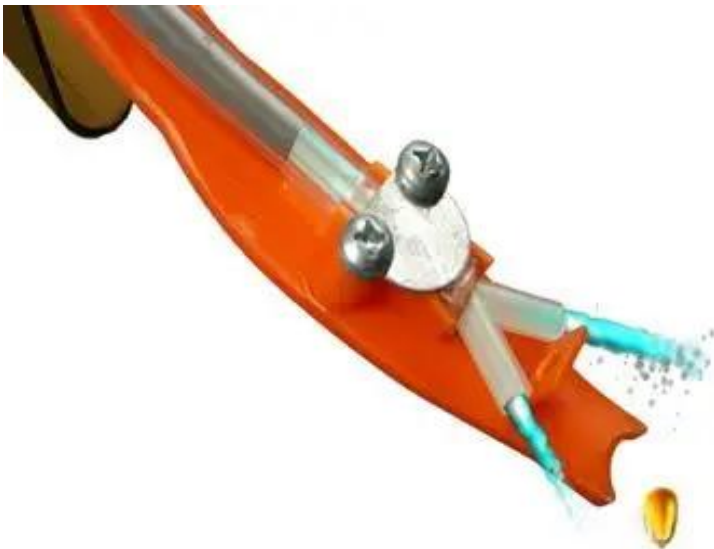
Рис 2.7. Полозок із конструкцією для внесення рідких добрив.
