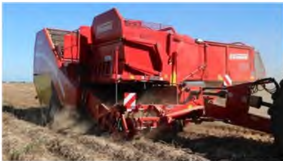
Рис. 1.2. Збирання картоплі комбайном із укладанням бульб у валок
