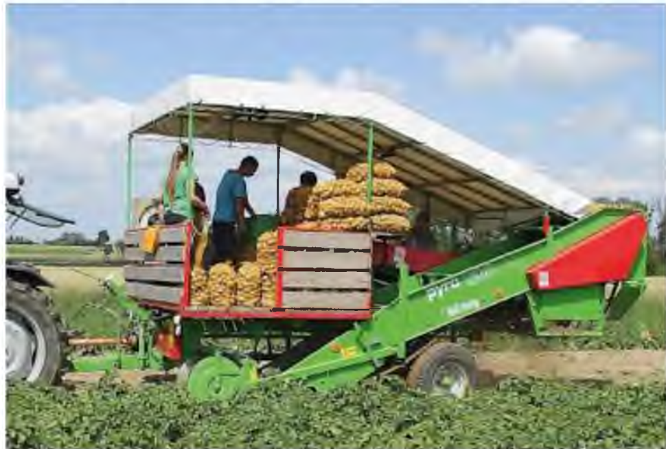
Рис. 1.5. Механізоване збирання картоплі з одночасним затарюванням зібраного врожаю у мішки
