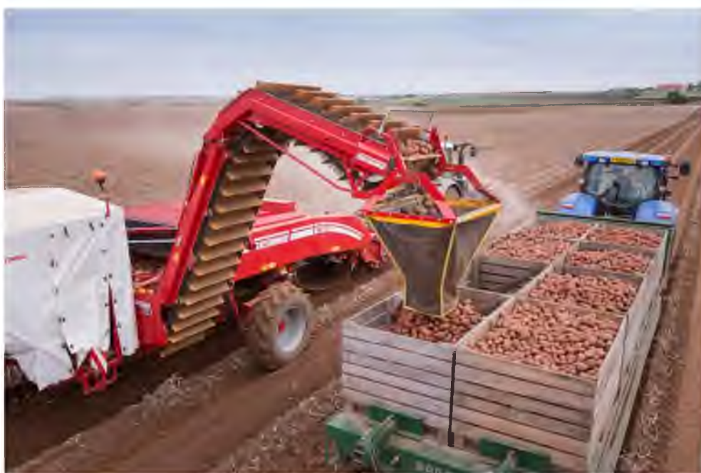
Рис. 1.8. Завантаження бульбами контейнерів на тракторному причепі для подальшого транспортування
