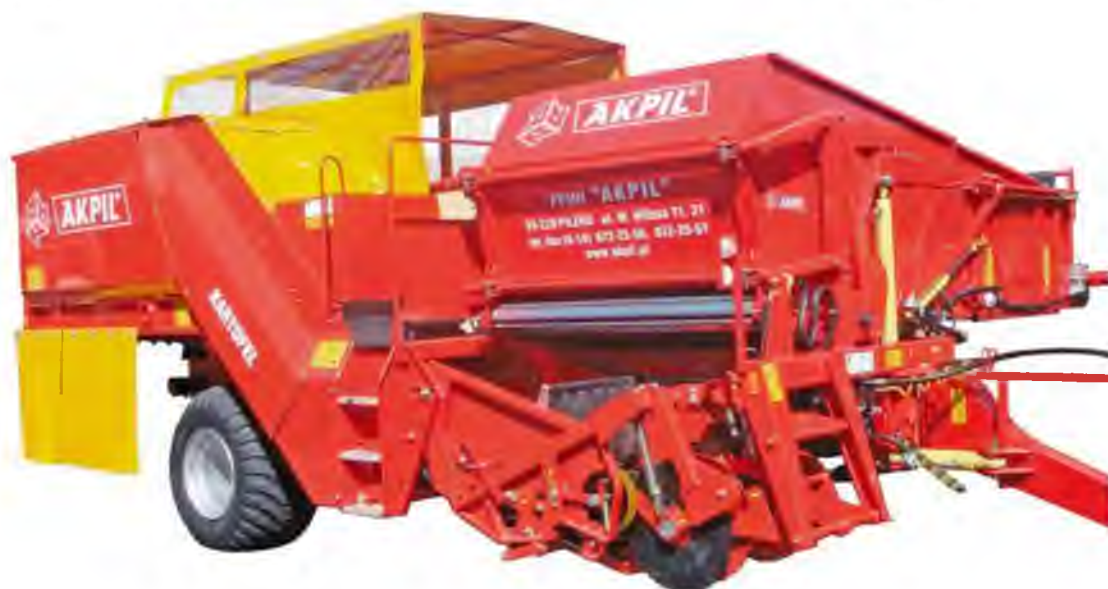
Рис. 2.5. Причіпний картоплезбиральний комбайн
