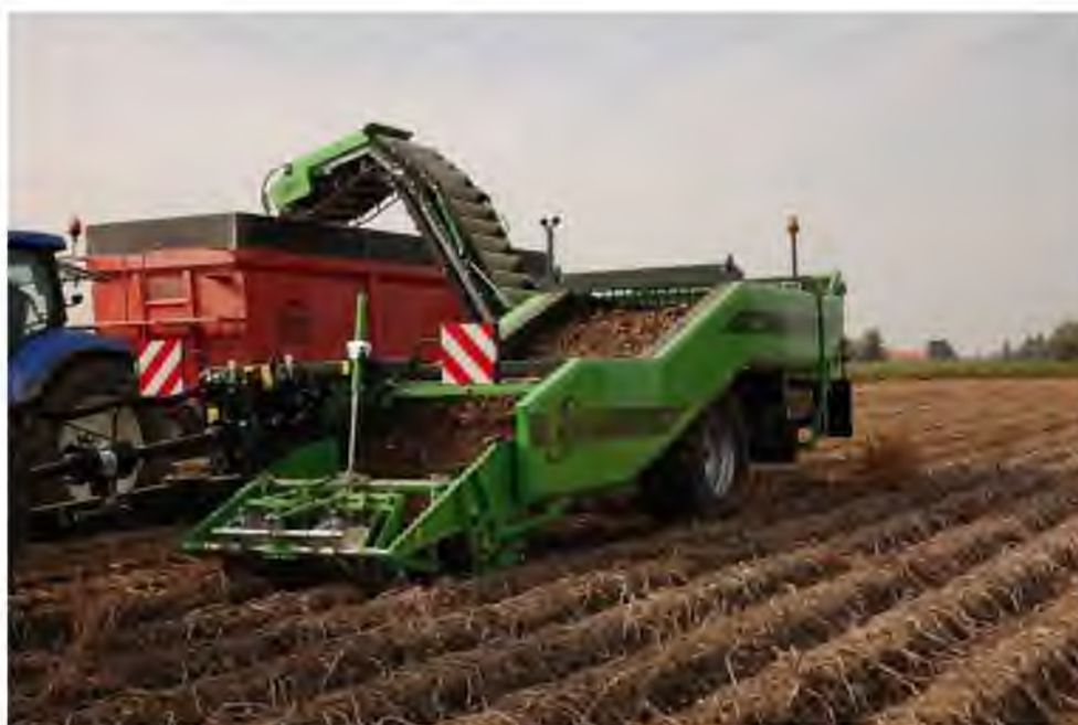
Рис. 2.6. Картоплекопач-навантажувач в процесі роботи
