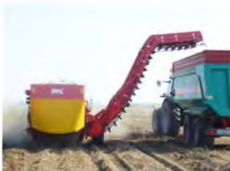
Рис. 1.1. Механізоване збирання картоплі елеваторним комбайном із одночасним завантаженням зібраних бульб у транспортний засіб
