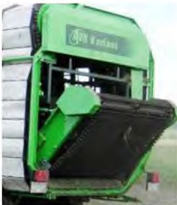
Рис. 2.16. Пальчата похила гірка в схемі збиральної машини
