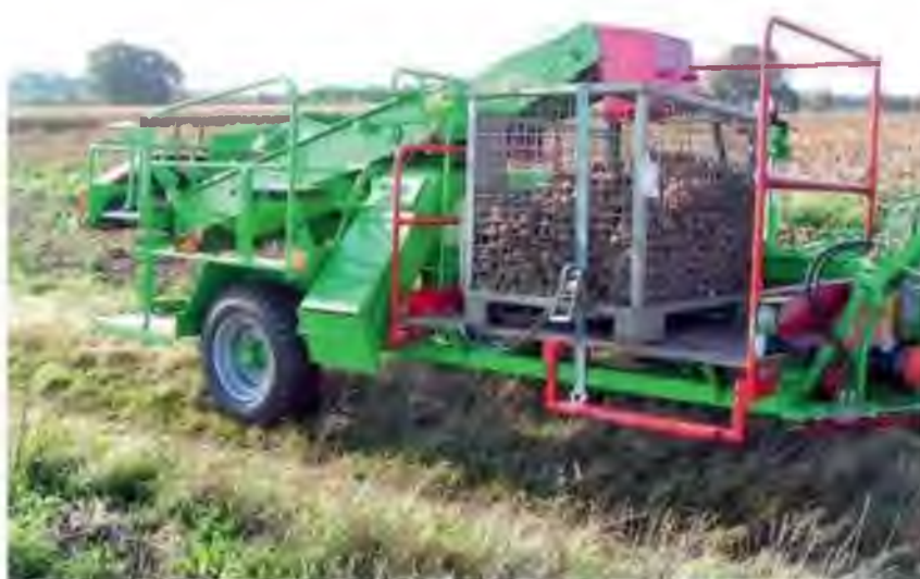
Рис. 1.4. Механізоване збирання картоплі із одночасним завантаженням у тимчасовий бункер
