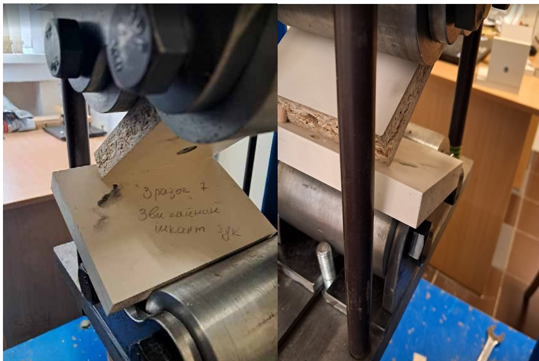
Рис. 3.20. Характер руйнування зразка №7
