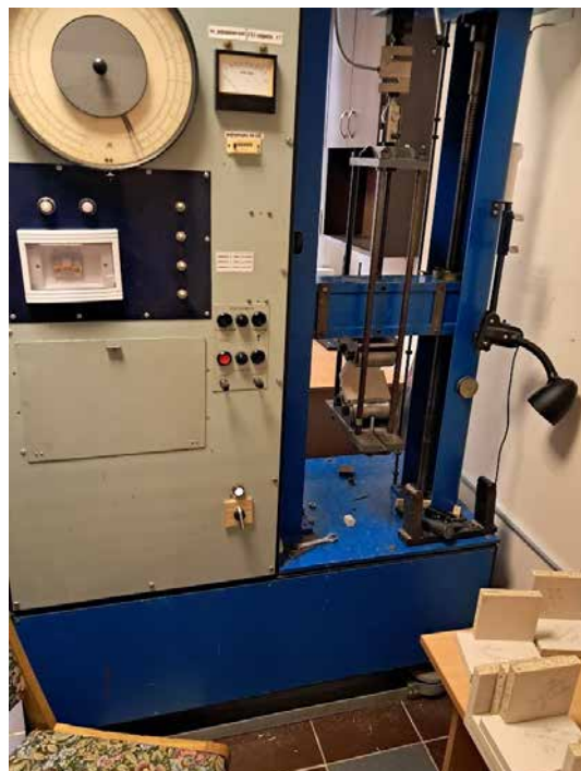
Рис. 3.1. Вигляд розривної машини зі встановленим пристосуванням При складанні меблевих заготовок стандартними шкантами результати
