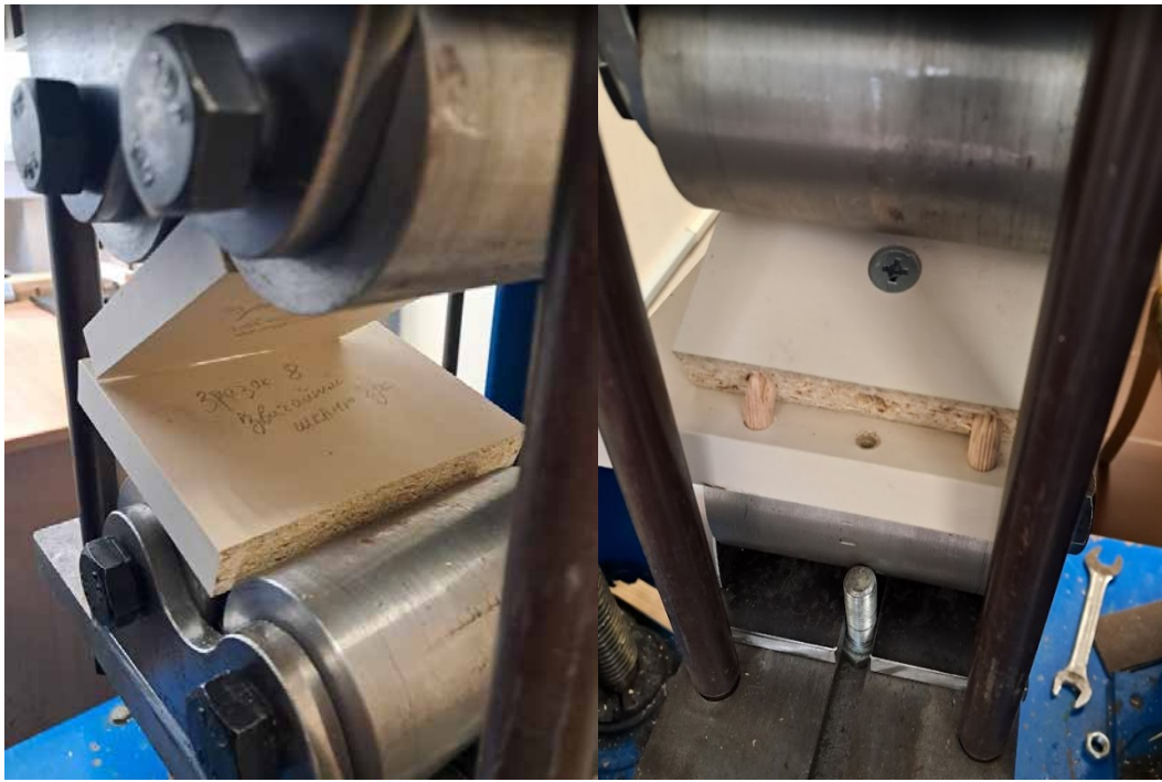
Рис. 3.23. Характер руйнування зразка №7
