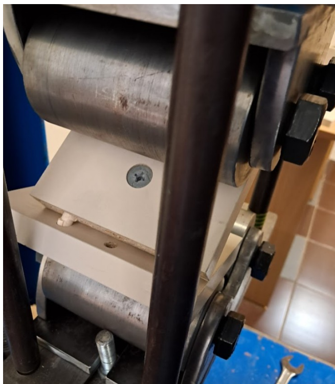
Рис. 3.10. Руйнування березового ексцентрикового шканта
