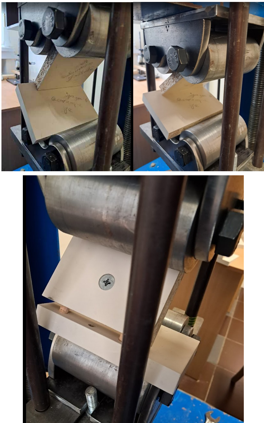
Рис. 3.18. Руйнування шкантив в зразку №6
