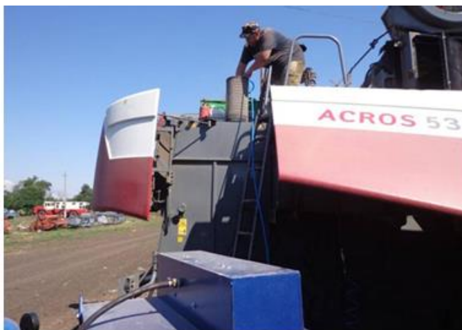
Рисунок 4.10 – Продувка фільтра повітрязабірника двигуна комбайну ACROS-530
