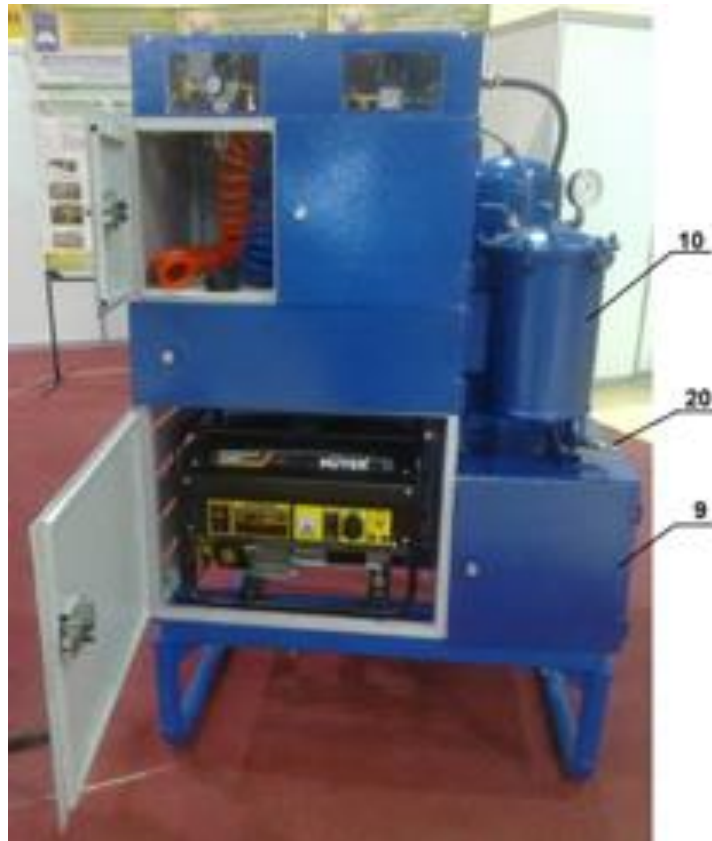
Рисунок 3.3 - Вид ззаду блоку з вбудованим бензогенератором
