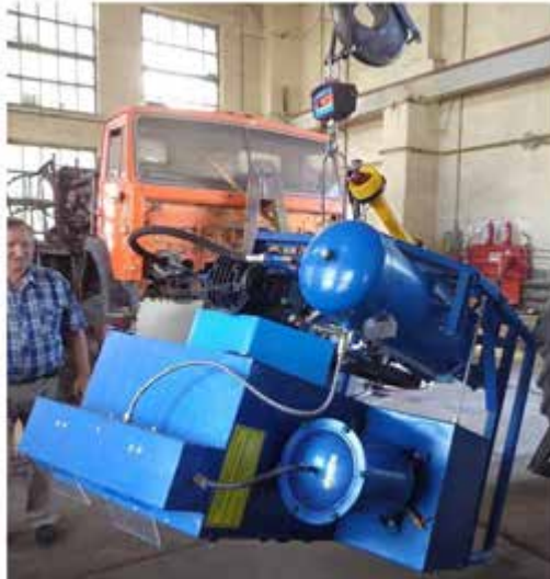
Рисунок 4.8 - Зважування і перевірка міцності конструкції агрегату за допомогою електроталі та підвісних ваг
