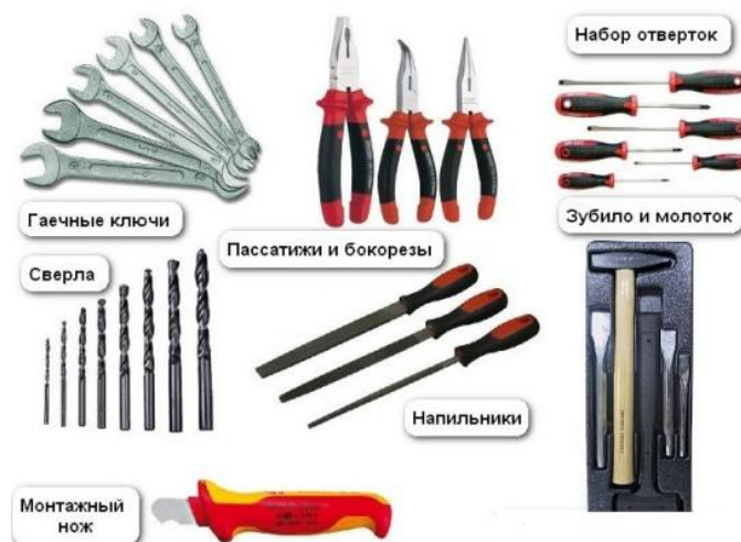
Рис. М21. Слюсарно-монтажний інструмент
