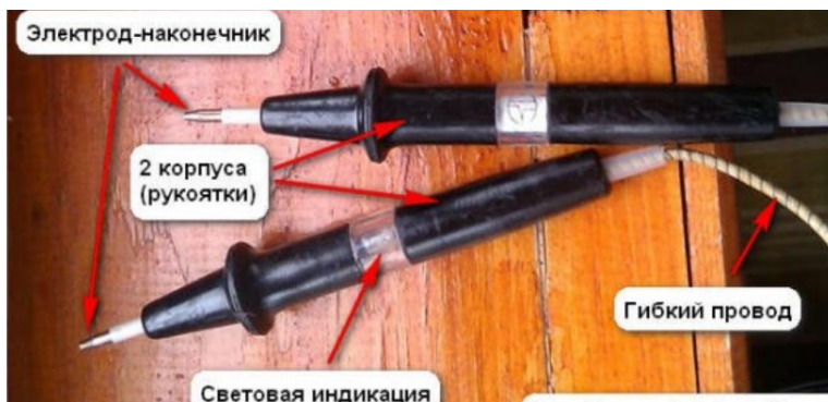
Рис. М10. Показчик напруги типу УНН
