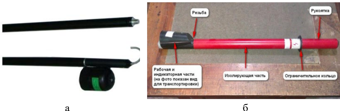
Рис. М3. Показчики напруги: а – УВН 35 – 110; УВНУ – 10
