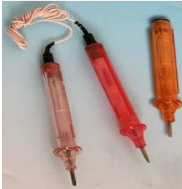
Рис. М9. Показчики напруги типу ЭИ0202, ЭИ0203
