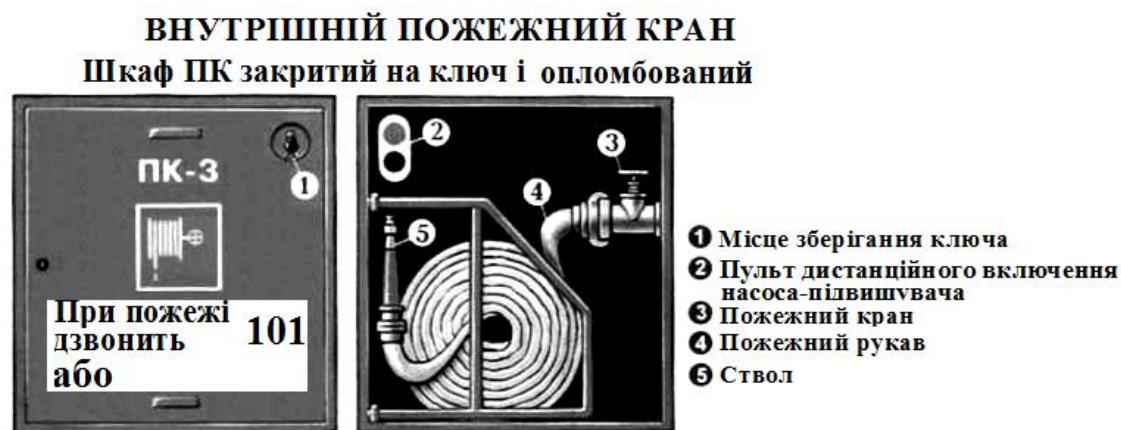
Рис. 7.2 – Внутрішній пожежний кран
