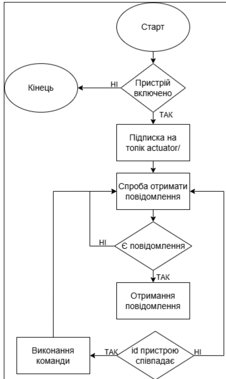
Рисунок 2.20 – Блок-схема алгоритму отримання команди з інтерфейсу
