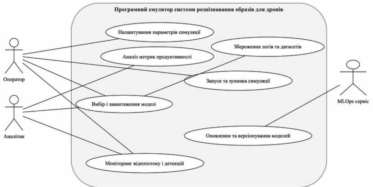
Рис. 1.14. Діаграма прецедентів програмного емулятора системи розпізнавання об'єктів для дронів
