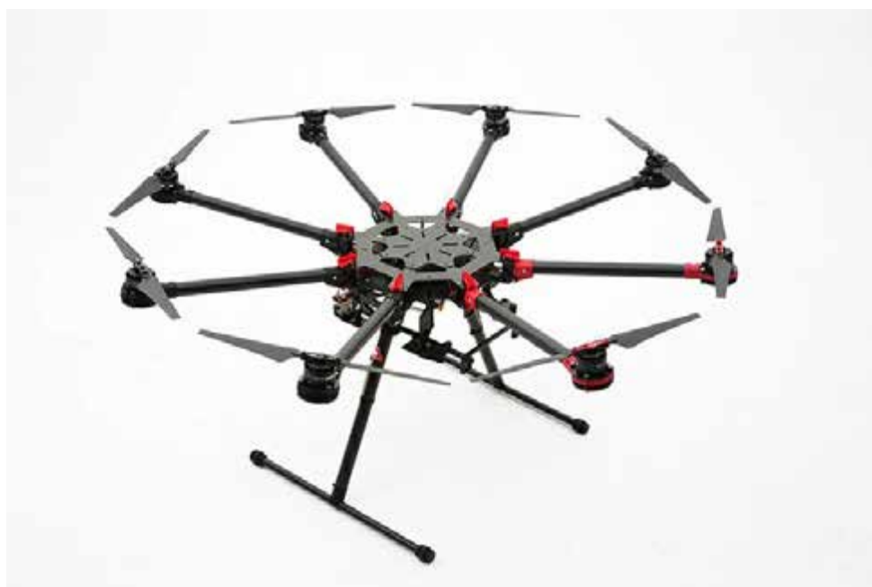
Рис. 1.7. Кострукція БПЛА мультироторного типу. Октокоптер [12]
