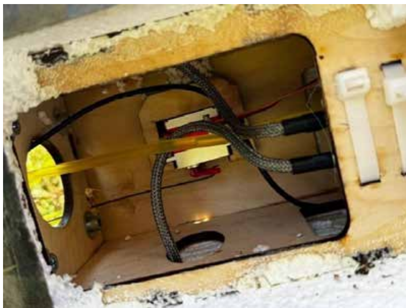
Рис. 1.10. Корпус БПЛА з використанням пінопласту [19]
