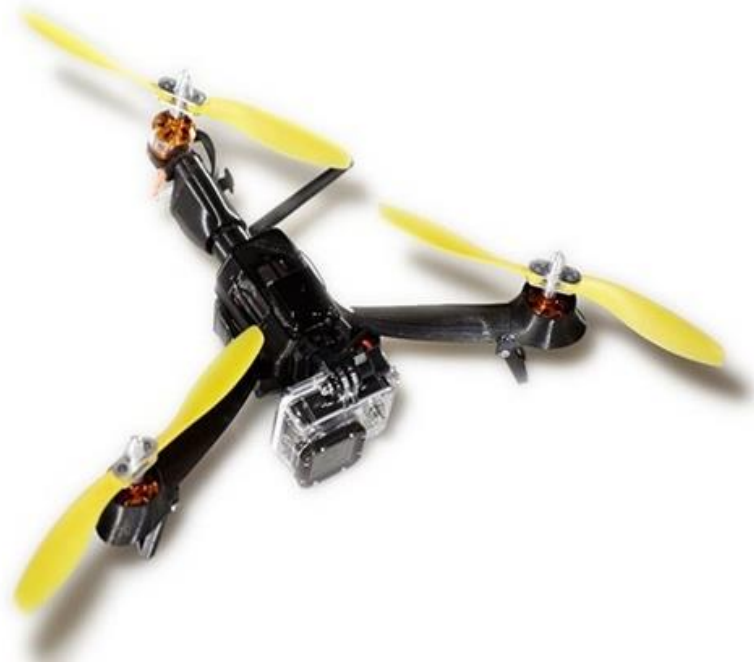
Рис. 1.3. Конструкція БПЛА мультироторного типу, трикоптер [5]
