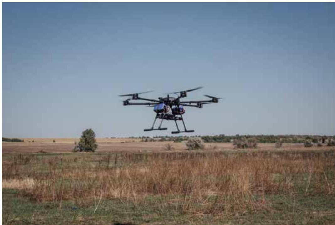
Рис. 1.6. Кострукція БПЛА мультироторного типу. Гексакоптер [10]
