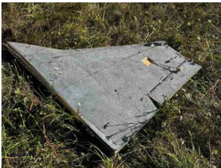
Рис. 1.12. Крило БПЛА з деревини [22]
