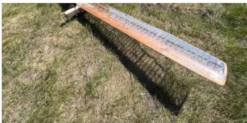
Рис. 1.8. Корпус БПЛА з склопластику та деревини [15]
