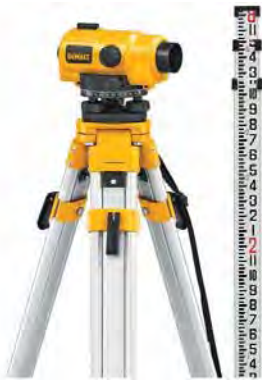
Сучасний оптичний нівелір з інварною нівелірною рейкою
