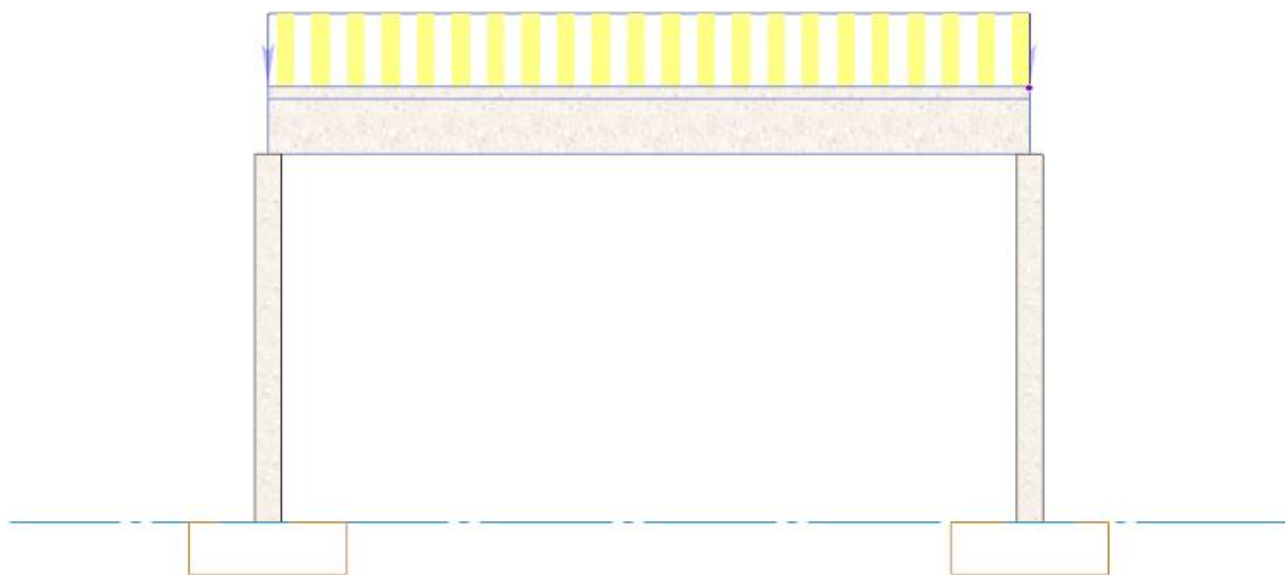
Рис. 2.4. Задання тимчасового снігового навантаження
