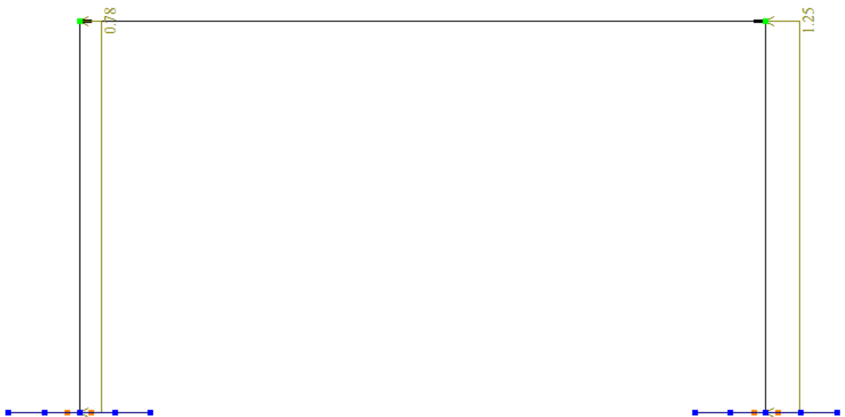
Рис. 2.6. Прикладання вітрового навантаження на поперечну раму «вітер справа»
