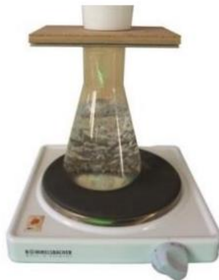
Рис. 2.14. Випробовування покриття на стійкість до дії водяної пари
