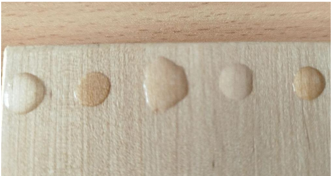
Рис. 3.5. Випробування на стійкість до плямоутворення
