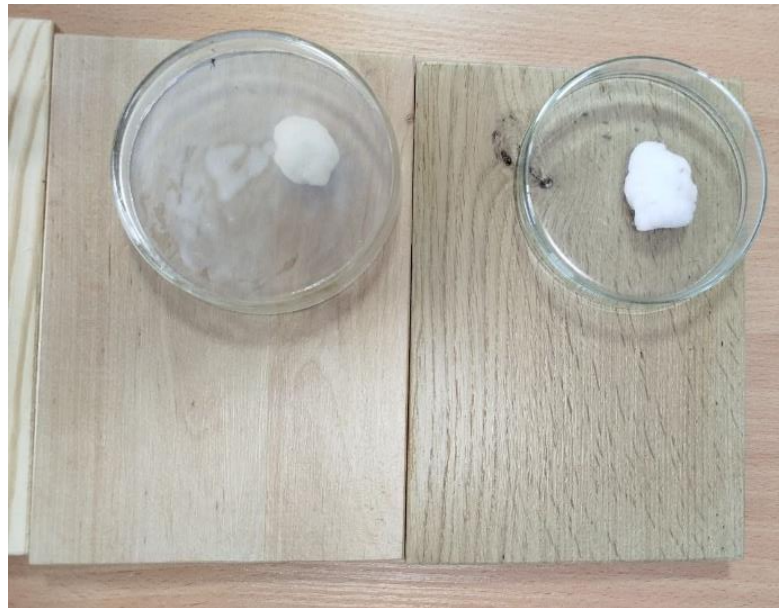
Рис. 3.6. Випробування на стійкість до дії води
