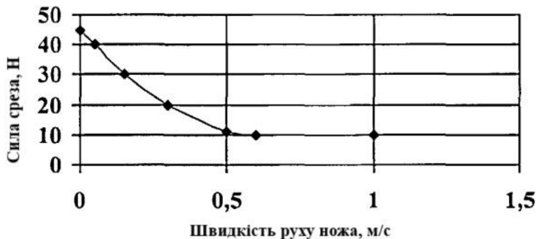
Рис. 1.2 - Залежність сили для зрізу вовни від швидкості руху ножа
