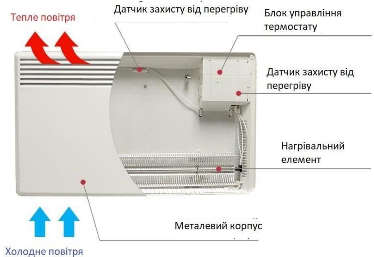
Рисунок 1.6 – Ілюстрація принципу роботи конвектору
