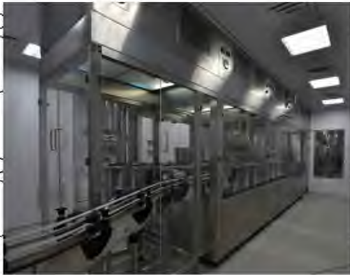
Рисунок 1.2. модуль односпрямованого потоку повітря
