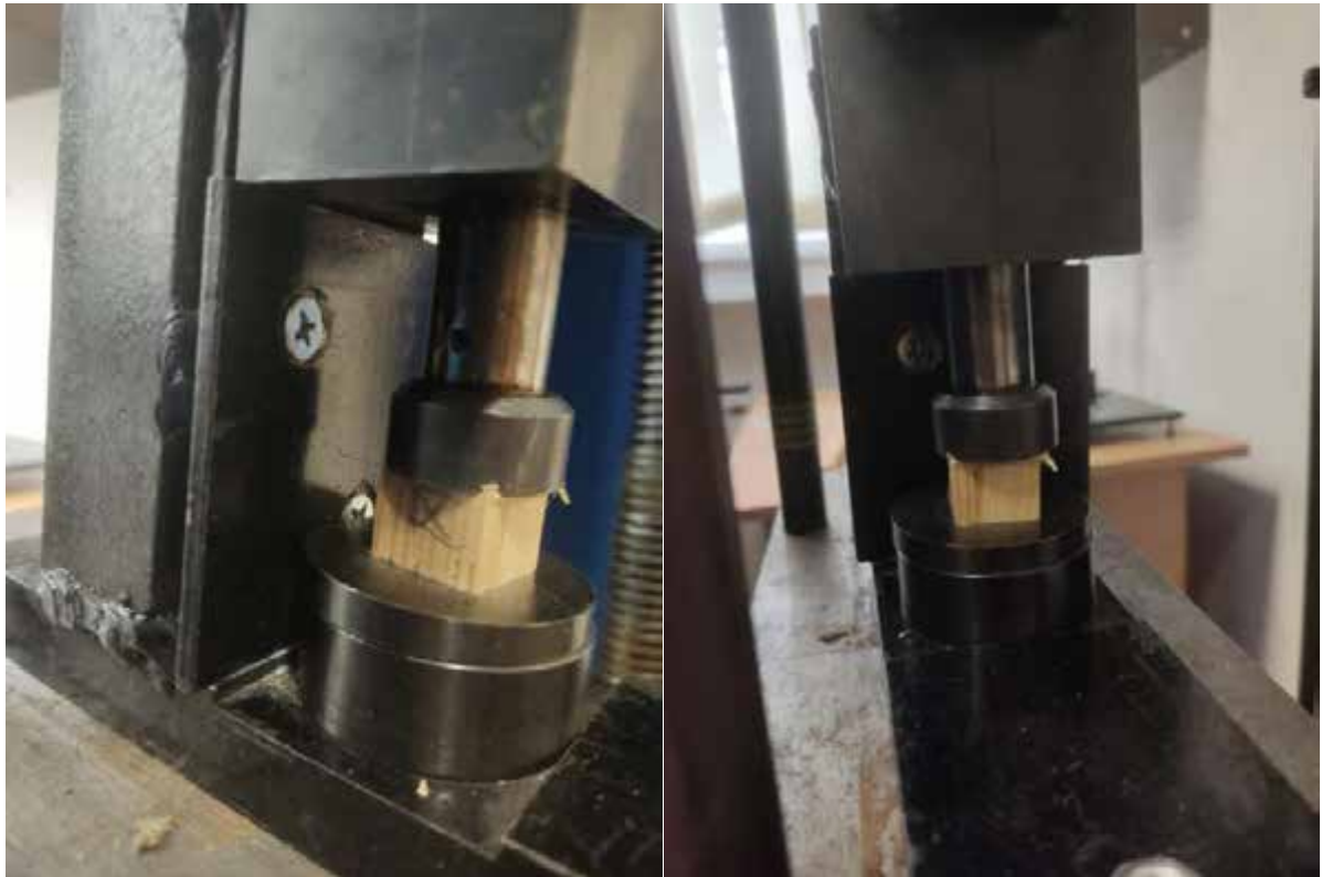
Рис. 3.12. Випробування зразків на стиск
