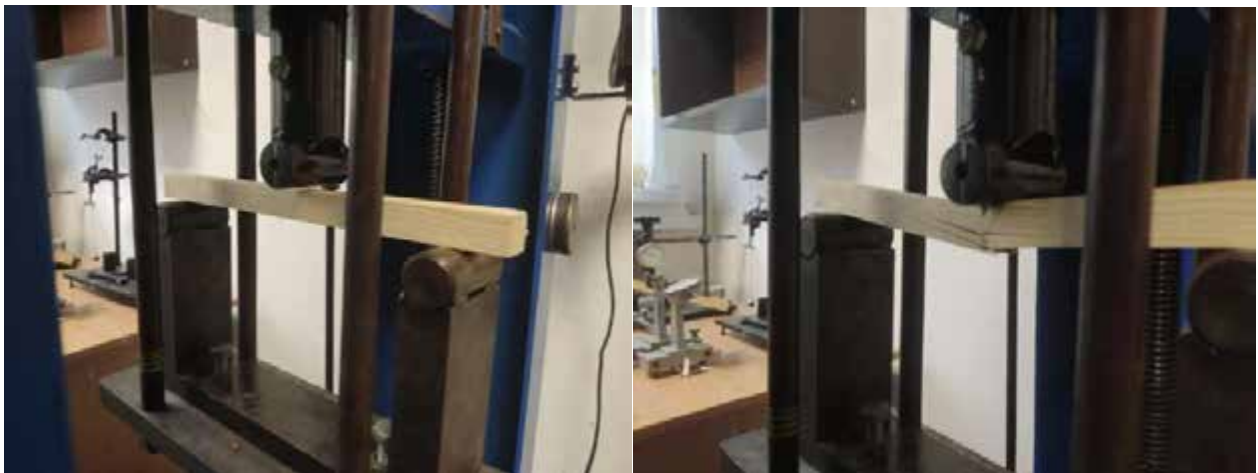
Рис. 3.17. Випробування зразків на статичний згин
