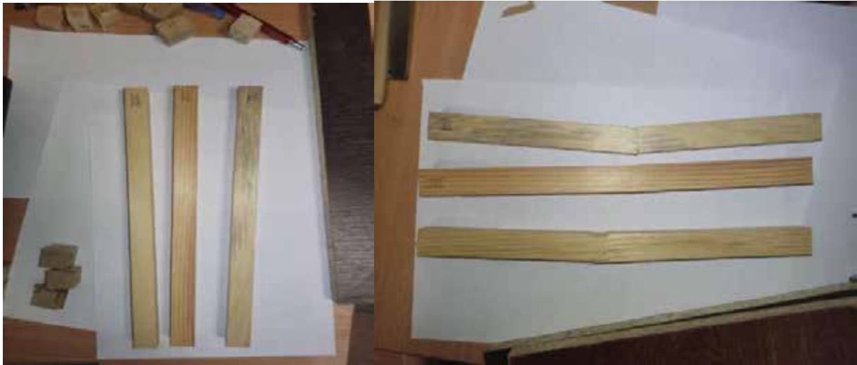
Рис. 3.16. Зразки для проведення дослідження на статичний згин
