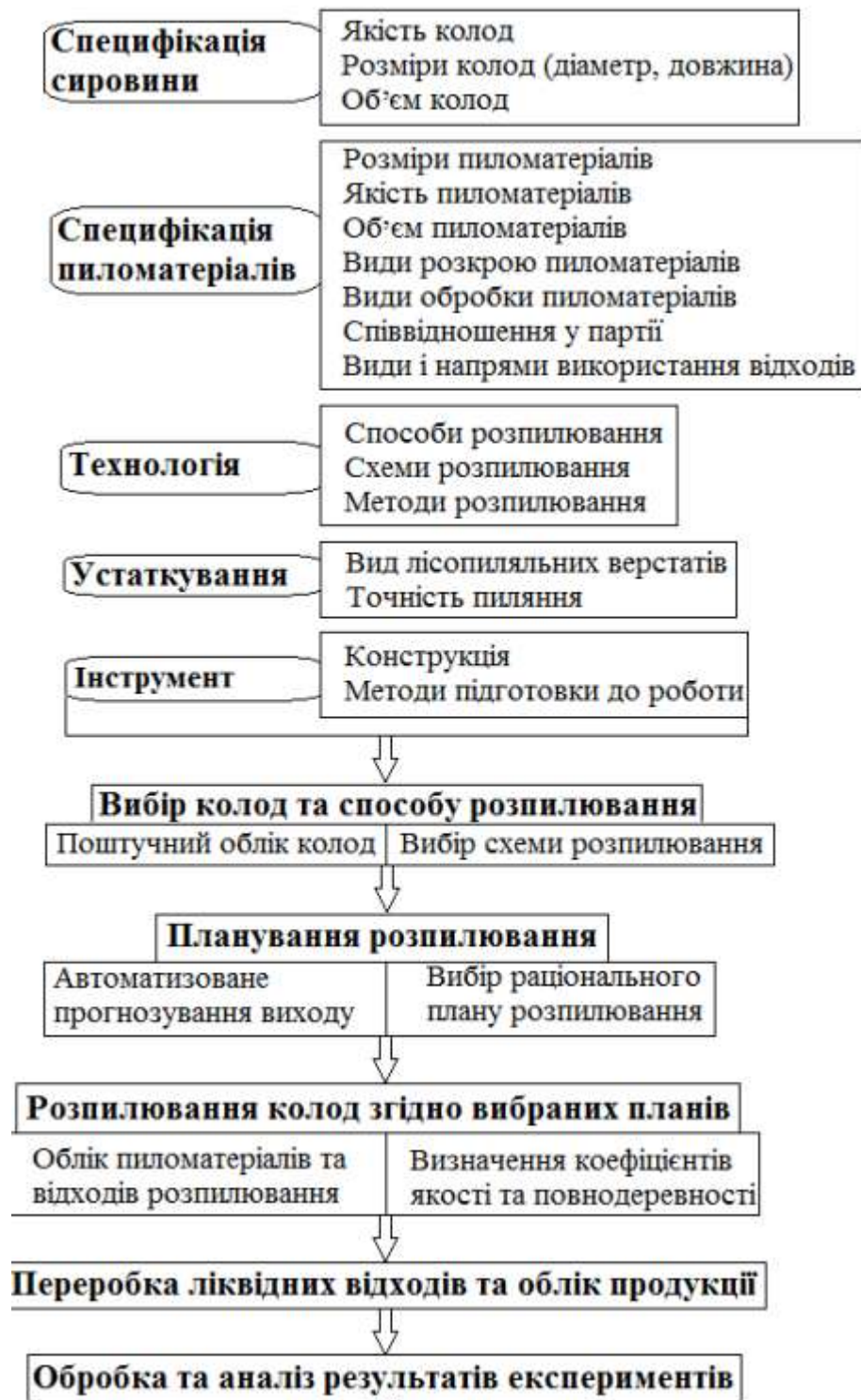
Рис. 3.1. Структура етапів та послідовність проведення експериментальних досліджень з визначення об'ємного та якісного виходу пиломатеріалів з пиловочної сировини
