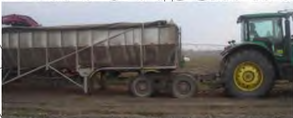
Рис. 2.7. Тракторний автопоїзд: напівпричіп з причепом підкатним візком
