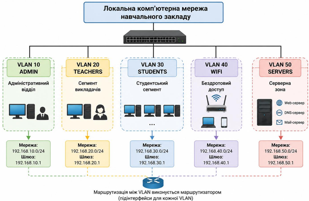
Рисунок 1.3 – Логічний поділ мережі навчального закладу на VLAN
