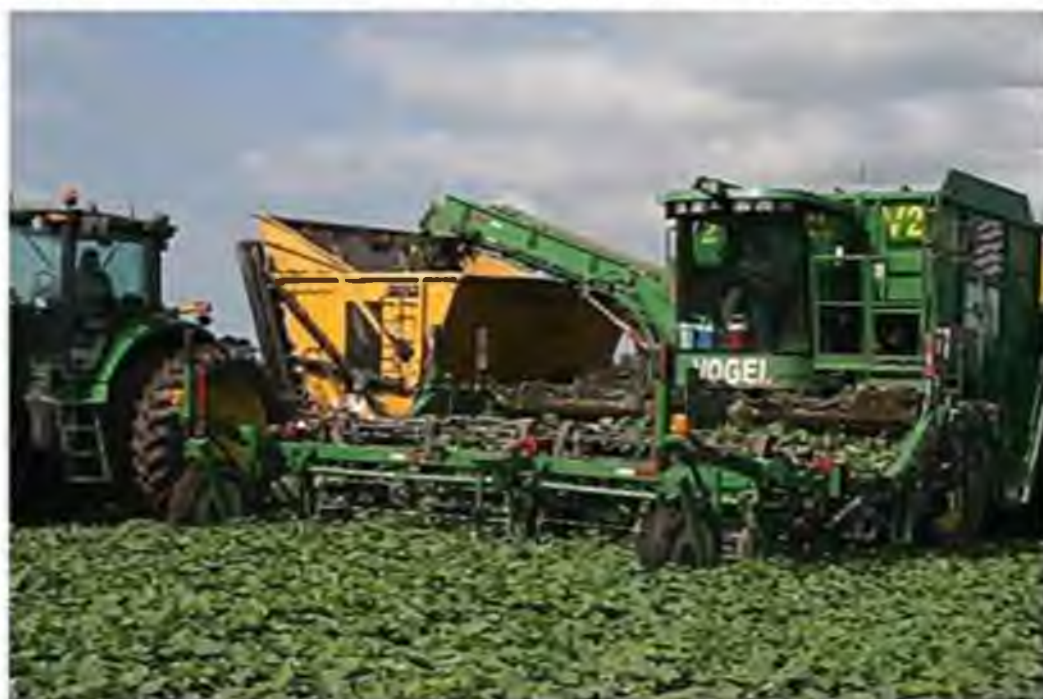
Рис. 2.13. Самохідний комбайн Vogel на збиранні огірків, штат Мічиган (США)
