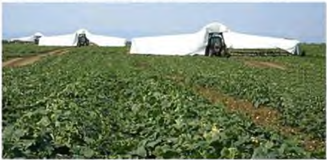
Рис. 2.11 Причіпний комбайн для збирання огірків Fleischmann ML 24
