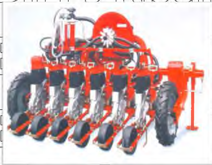
Рис. 2.3. Шестирядна пневматична овочева сівалка АГРІКОЛА
