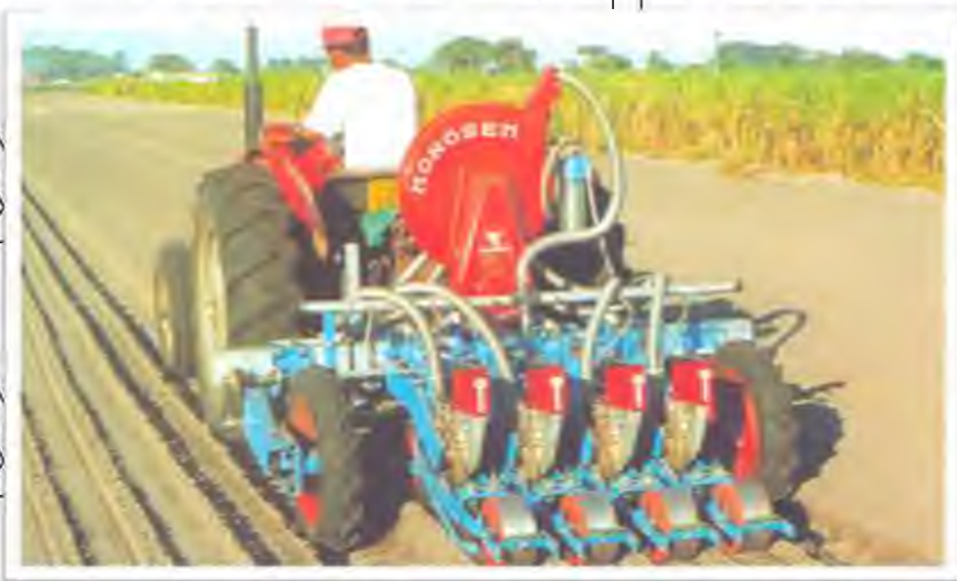
Рис. 2.8 Чотирьохрядна овочева сівалка MONOSEM MS
