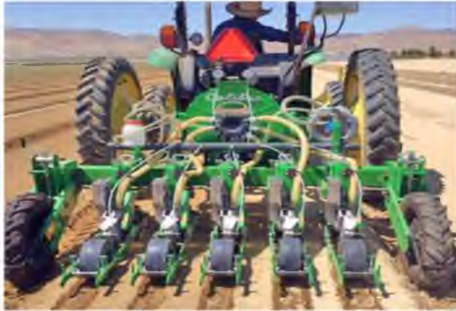
Рис. 2.9. Пневматична сівалка точного висіву овочевих культур SFOGGIA CALIBRA
