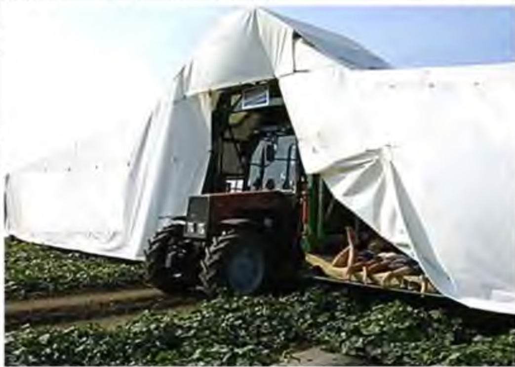
Рис. 2.16. Флігер-платформа для збирання огірків (Gurkenflieger) комбайн Fleischmann ML 24
