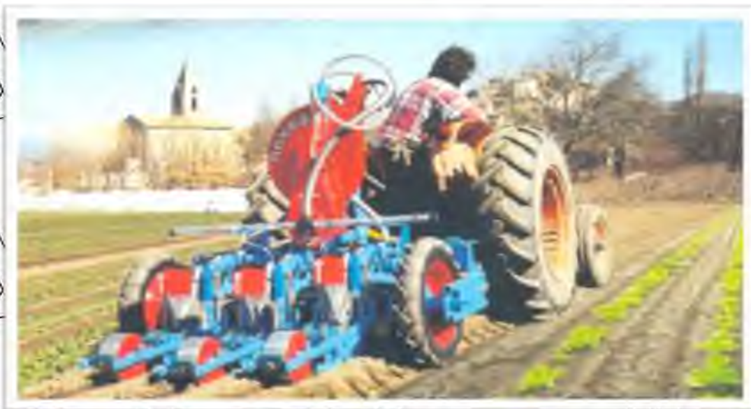
Рис. 2.6 Трьохрядна овочева сівалка MONOSEM MS
