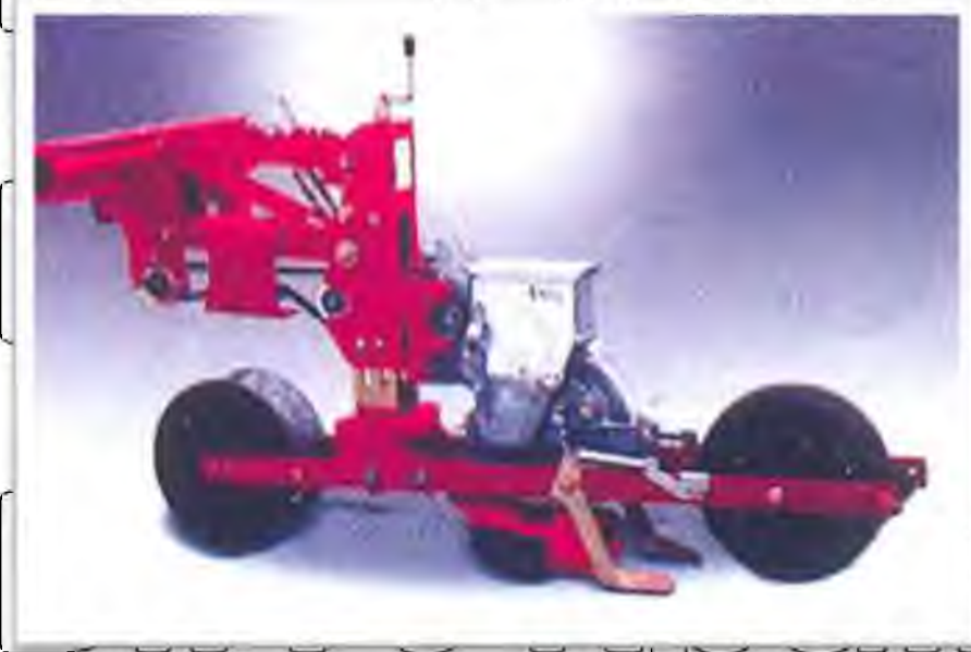
Рис. 2.5. Висівна секція пневматичної овочевої сівалки АГРІКОЛА
