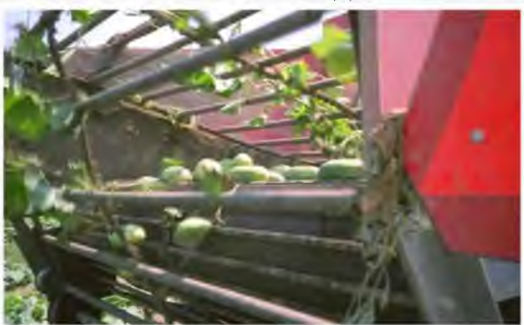
Рис. 2.15. Вивантажувальний транспортер огіркового комбайна Pk Rite (США)
