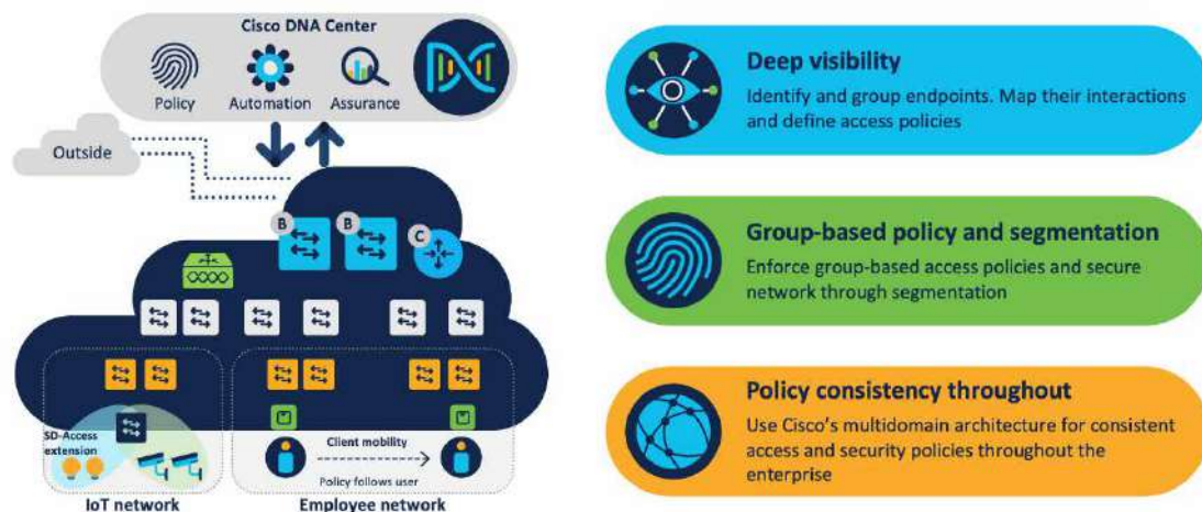
Рисунок 1 – Архітектура Cisco Software-Defined Access
