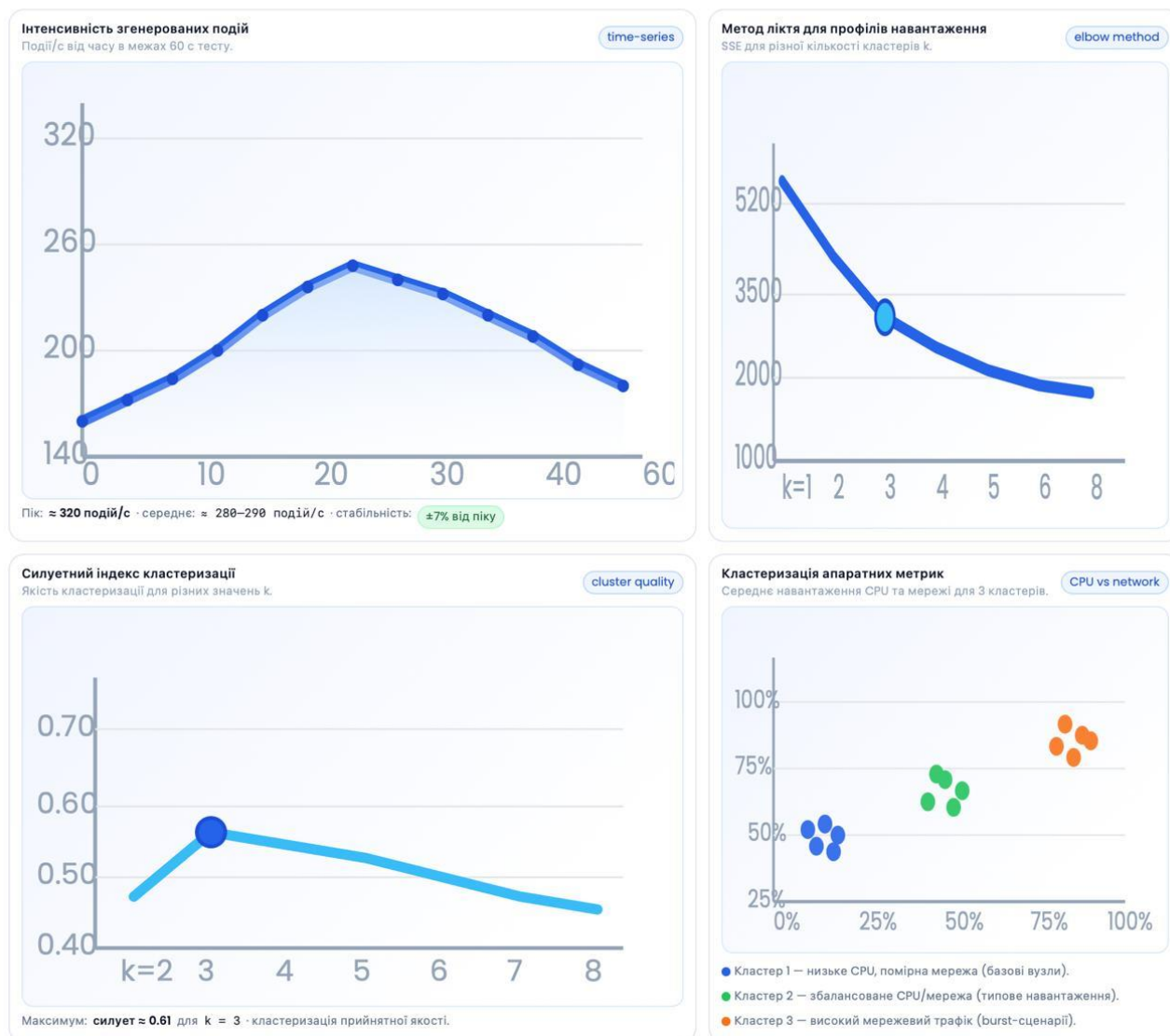
Рис. 4.2 – Аналітичні результати тестування: часові ряди інтенсивності, метод ліктя, силуетний індекс і кластеризація апаратних метрик
