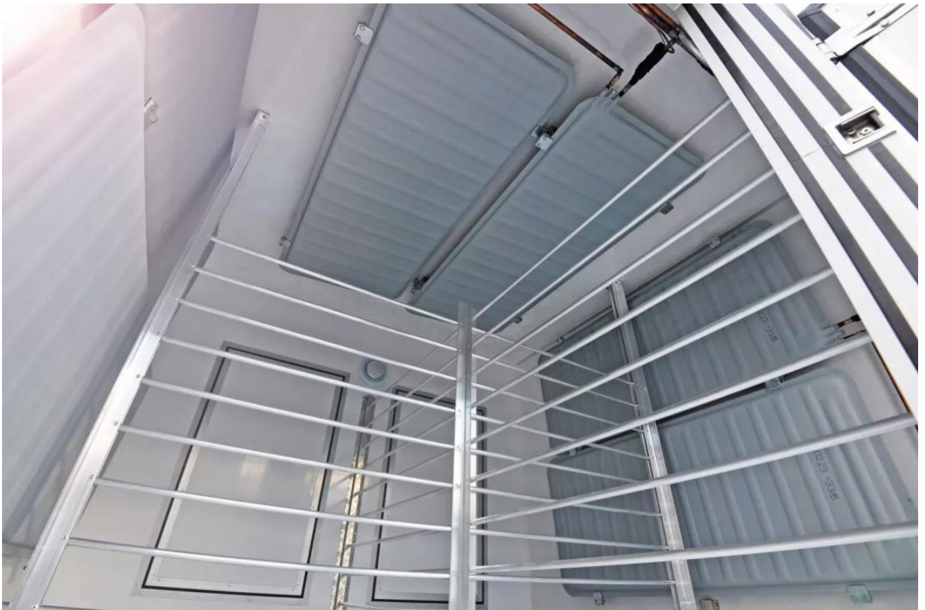
Рис.2.4. Перегородки мультитемпературних автомобілів
