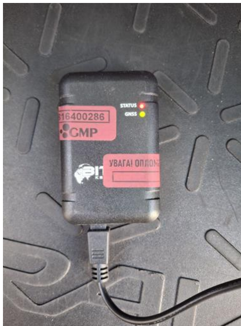
Рис. 3.8 GPS-трекер Bitrek BI 450 Trek
