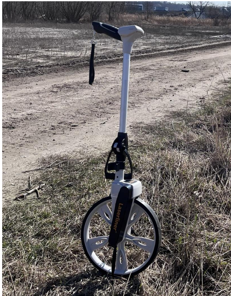
Рисунок 3.4 - Електронне дорожнє вимірювальне колесо (курвіметр) Laserliner RollPilot S12
