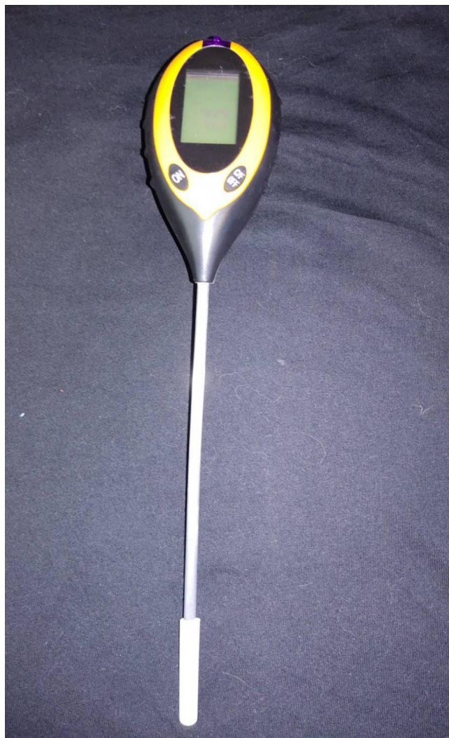
Рис. 1.1. Аналізатор ґрунту Soil Survey Instrument (Власне фото)
