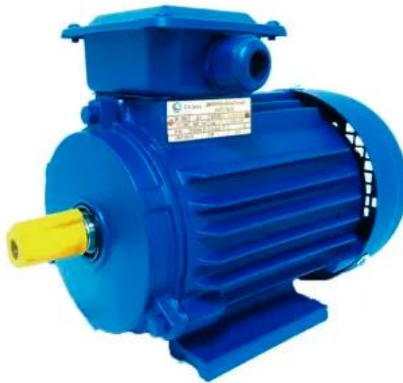
Рис. 3.4. Трьохфазний промисловий асинхронний електродвигун з короткозамкненим ротором АІР80А2
