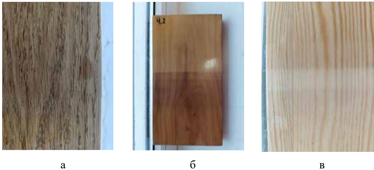
Рис. 4.16. Результат дослід на лаку Maxima Ultra Woodcare (а-дуб, б-груша, в-сосна)
