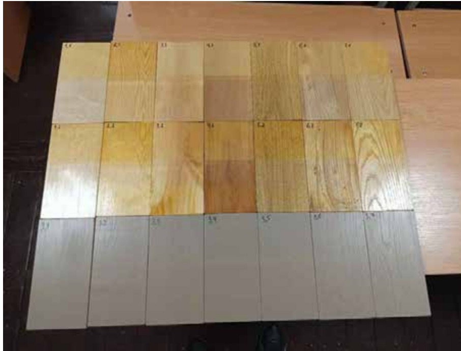
Рис. 4.5. Зразки після випробування на дію УФ-випромінювання
