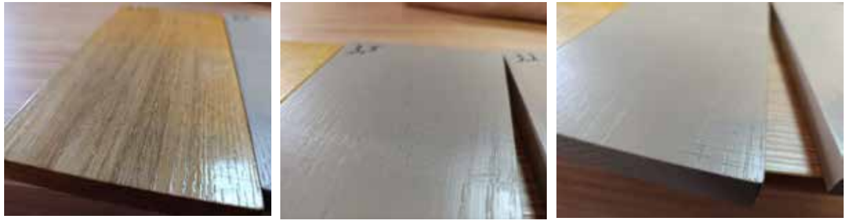
Рис. 4.20. Решітчасте надрізування на зразках сосни
