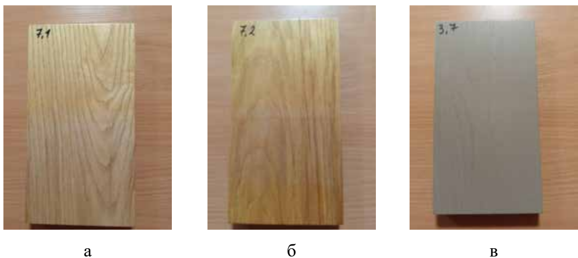
Рис. 4.12. Зразки ясеню (а- лак Maxima acrylic panel varnish, б-лак Maxima Ultra Woodcare, в -лак Hartwachs-Ol Farbig)
