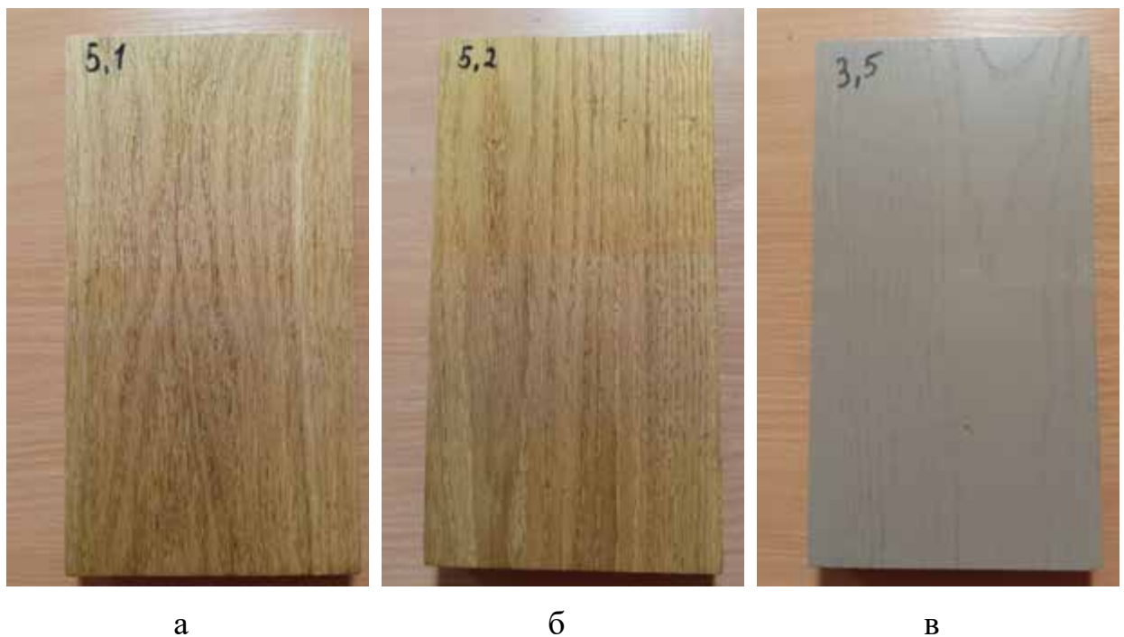
Рис. 4.10. Зразки дубу (а- лак Maxima acrylic panel varnish, б-лак Maxima Ultra Woodcare, в-лак Hartwachs-Ol Farbig)
