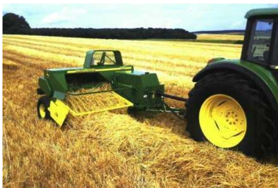
Рис. 1.5. Прес-підбирач John Deere 359
