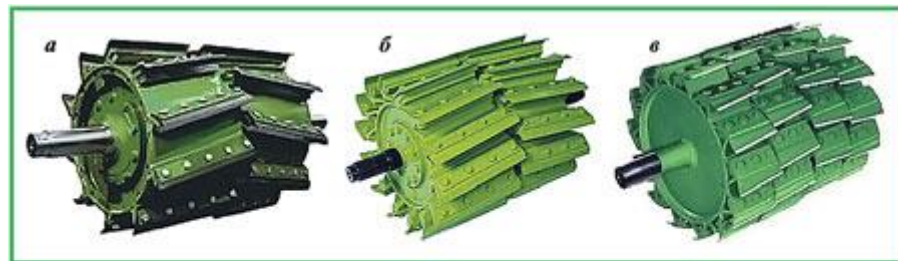
Измельчающие барабаны кормоуборочных комбайнов а – фирма Krone; б – фирма Claas; в – барабан Dura-Drum фирмы John Deere
