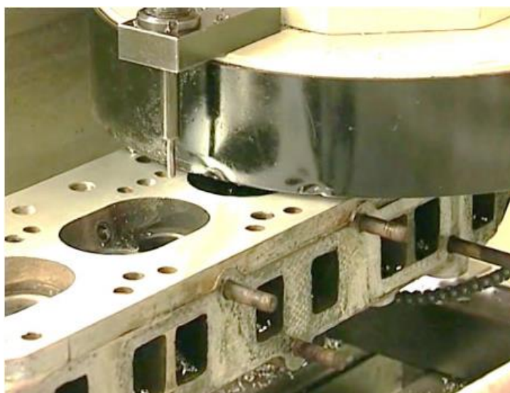
Рис. 2.5 Фрезерування площини головки блоку циліндрів
