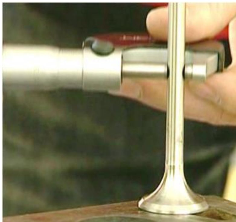
Рис. 3.1 Визначення зносу стержня клапана
