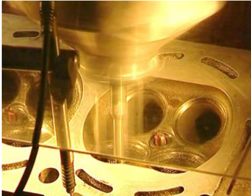
Рис. 3.4 Розточування напрямних втулок
