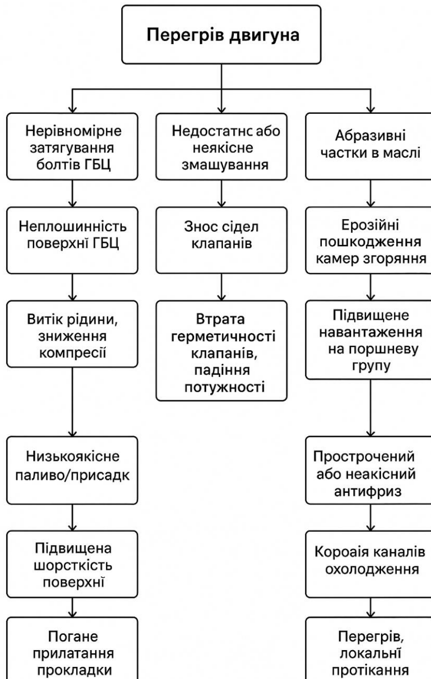
Рис. 2.5 Схема взаємозв'язків дефектів та їх причин
