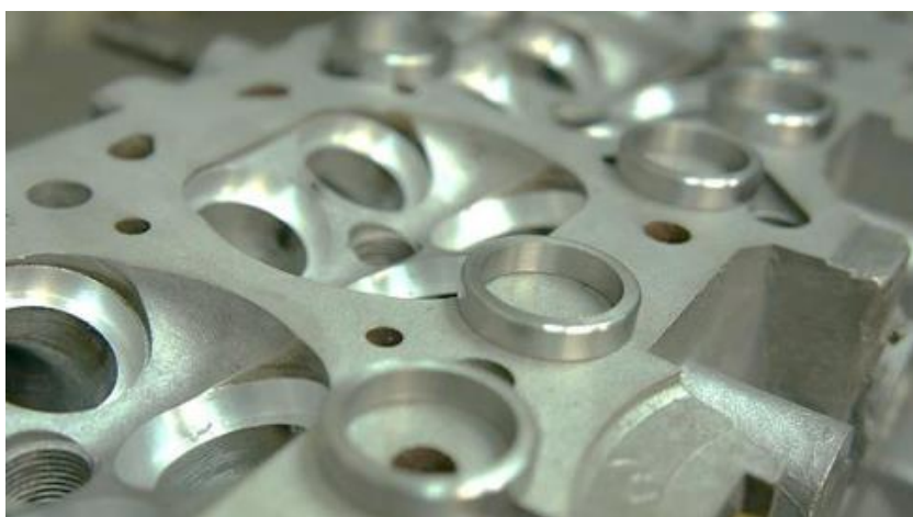
Рис. 3.5 Комплект сідел, що відповідають розмірам гнізд у головці блоку циліндрів
