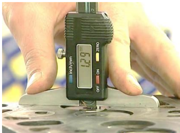
Рис. 2.6 Перевірка глибини залягання клапана
