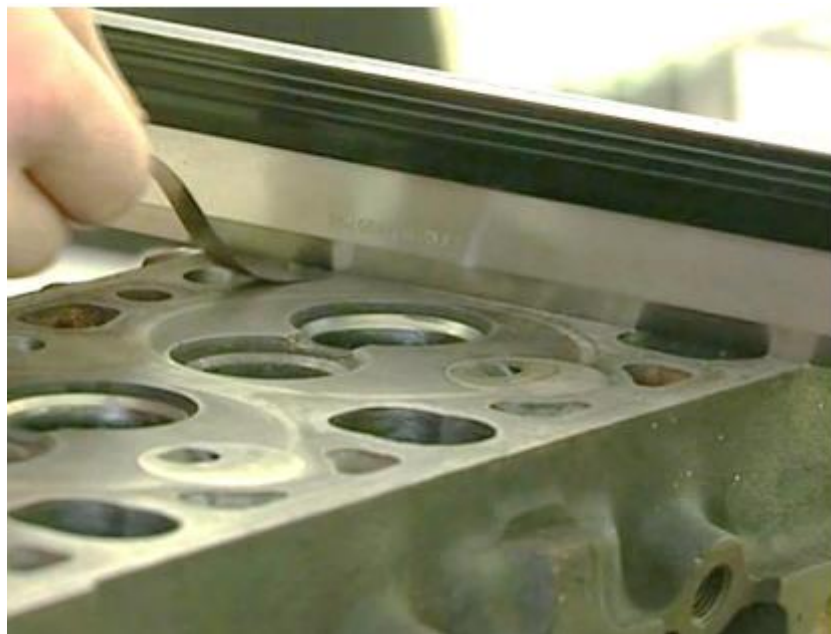
Рис. 2.4 Перевірка площини прилягання головки блоку циліндрів
