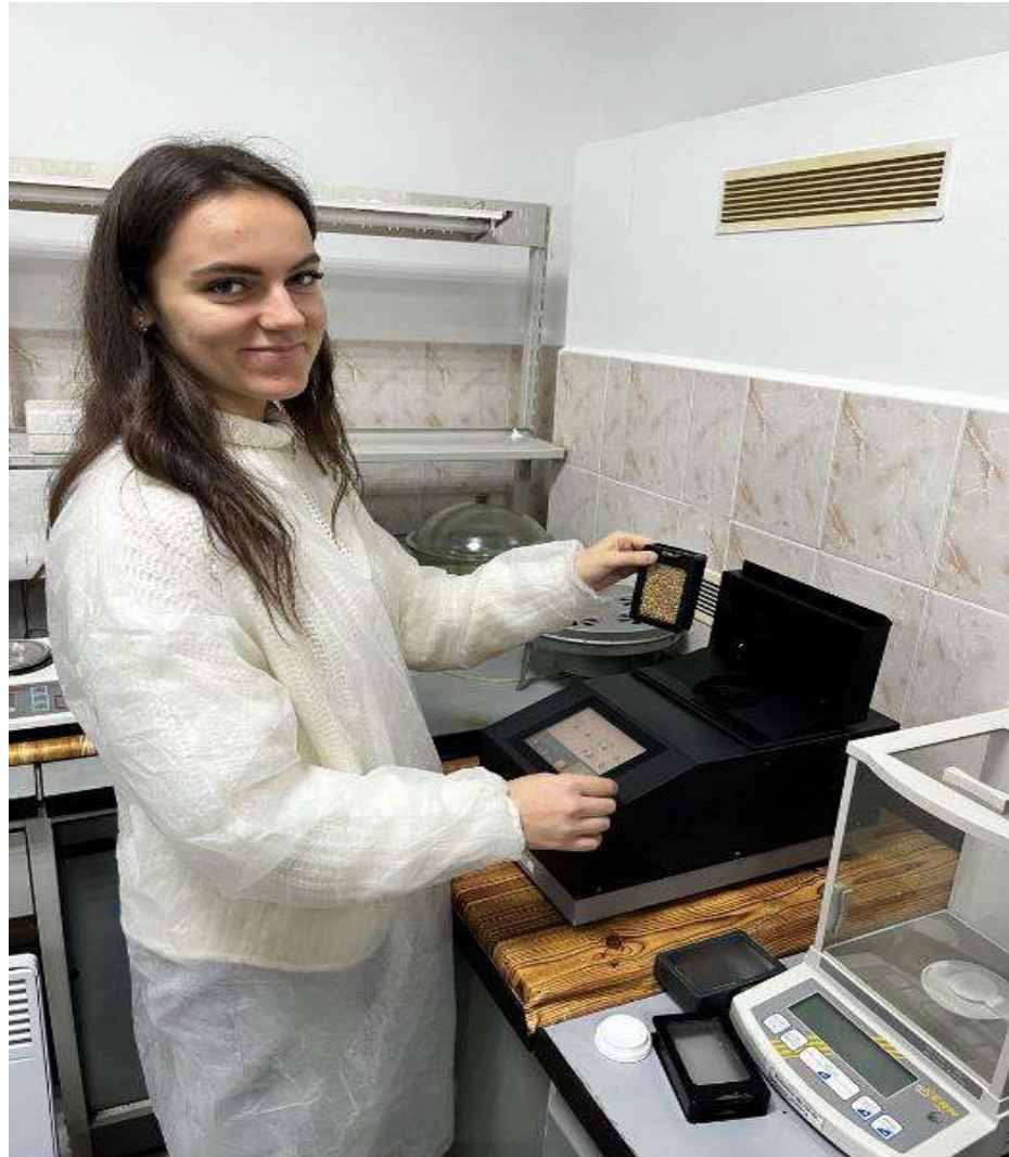
Рис. 2.1. Визначення технологічних показників якості зерна пшениці озимої на Kett AN-920
