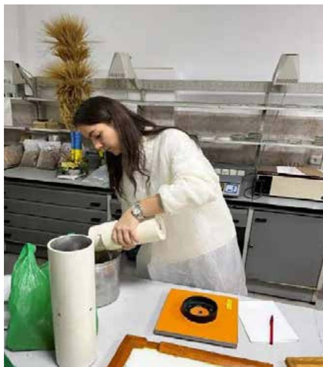
Рис. 2.2. Визначення натуре зерна пшениці озимої на літровій пурці
