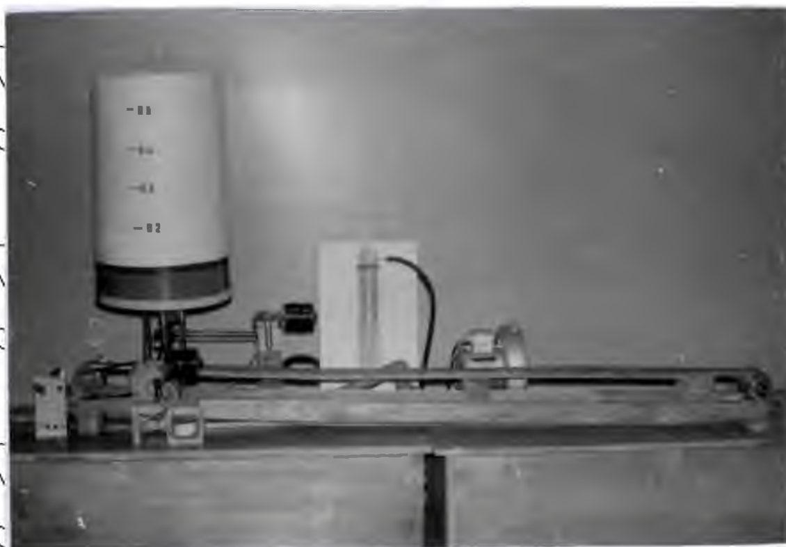
Рис. 3.3. Лабораторна установка для визначення конструктивно-технологічних параметрів висівного апарата
