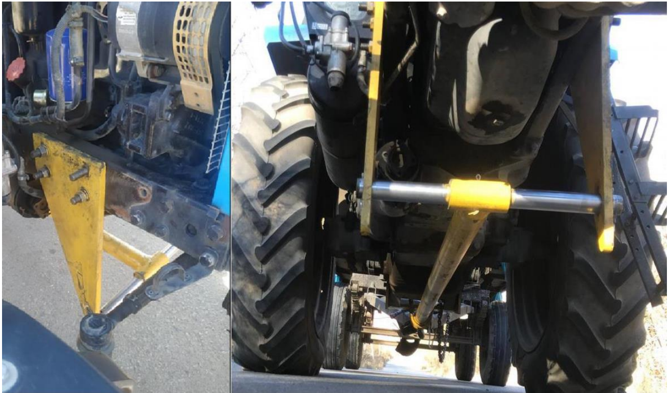
Рис. 4.24. Кутові кронштейни, встановлені на тракторі.
