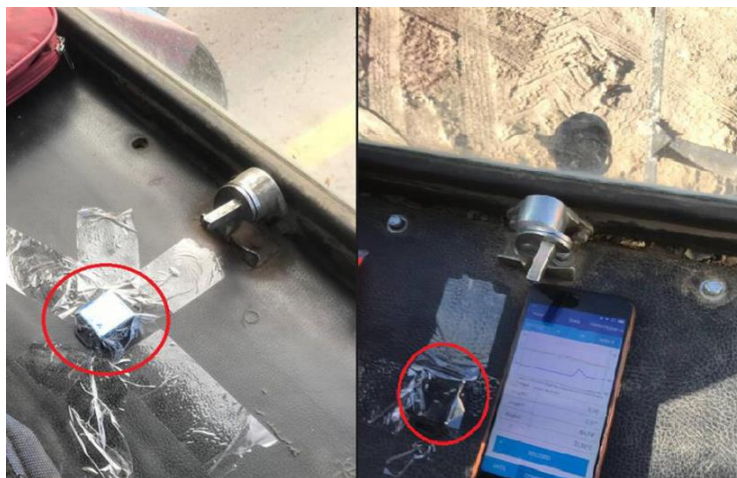
Рис. 4.2. Фрагмент проведення досліджень щодо відхилення від прямолінійного руху заднього моста трактора (ліворуч-серійний трактор, праворуч-експериментальний трактор).
