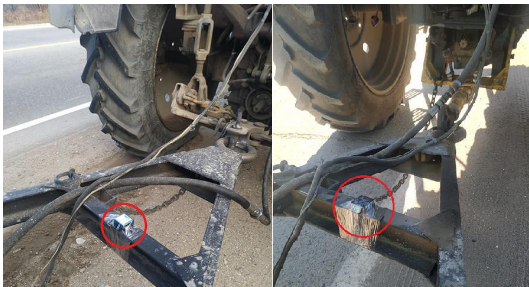
Рис. 4.3. Фрагмент проведення досліджень щодо відхилення від прямолінійного руху вузла «тягово-зчіпний пристрій трактора-дишло причепа» (зліва-серійний трактор, справа-експериментальний трактор).
