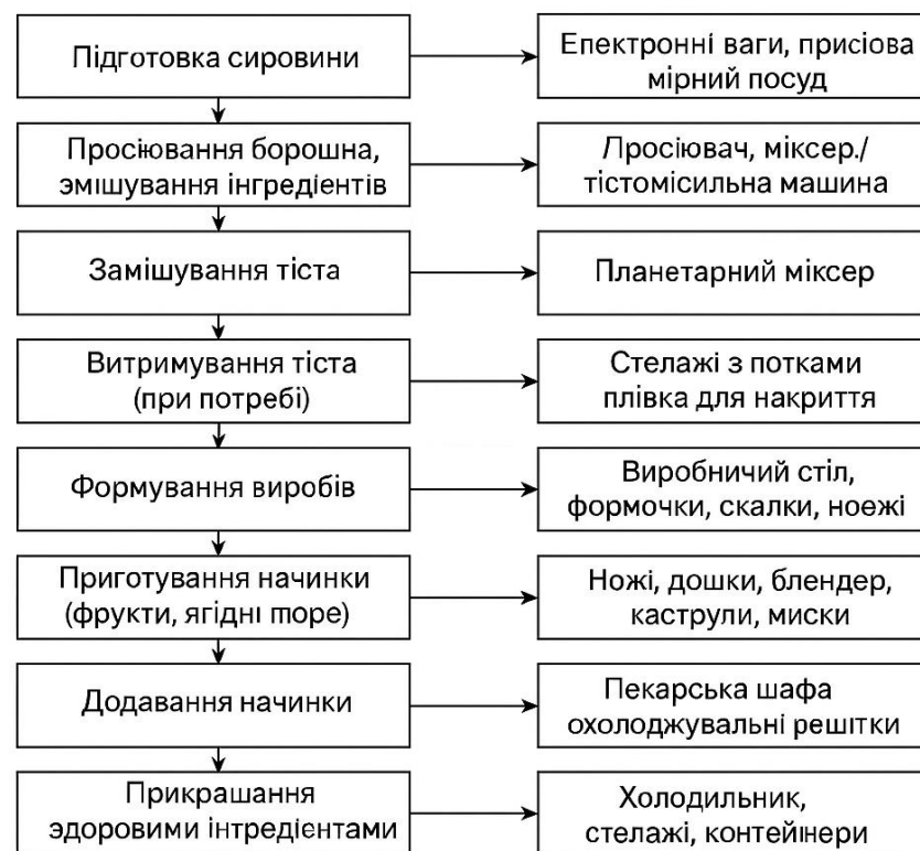
Рис. 2.1 – Структурно-технологічна схема виробничого процесу приміщення для кондитерських виробів.
