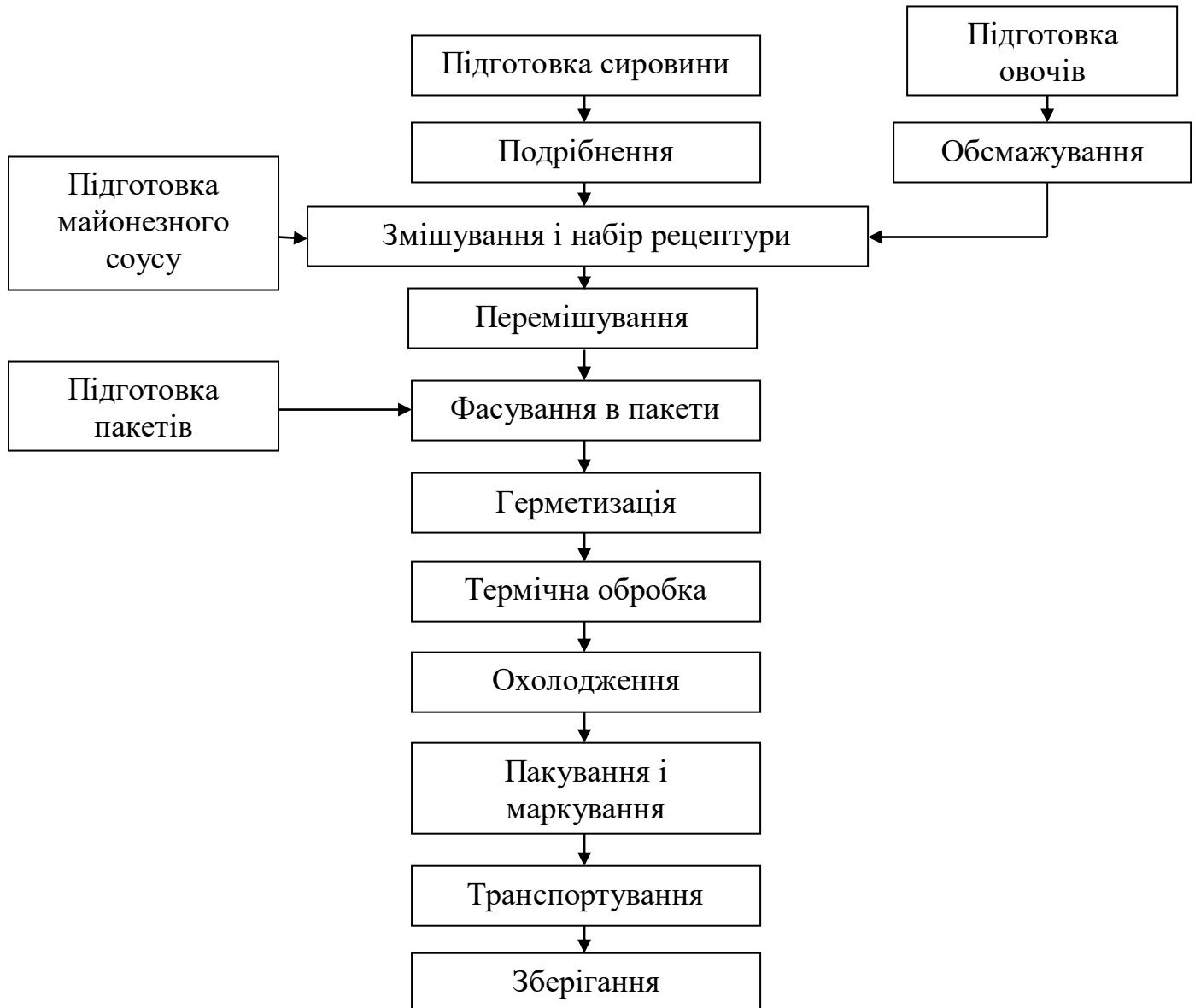
Рис. 4.1. Технологічна схема виробництва кулінарних виробів з молюсків в емульсійних соусах в полімерних пакетах
