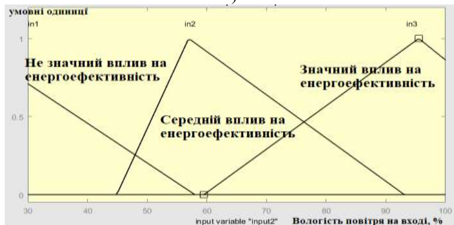
Рис. 6.3. Функції приналежності енергоефективних параметрів якості регулювання а) температури б) вологості в спорудах закритого ґрунту
