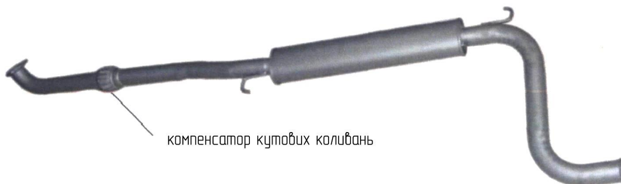
Рисунок 2.6 – Глушник додатковий з металокомпенсатором кутових коливань
