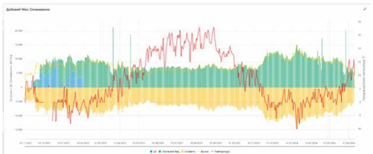
Рис. 3.15. Річні дані балансу по генерації дизель-генератора, основного вводу, добовому споживанню 300 будинків в залежності від температури зовнішнього середовища.
