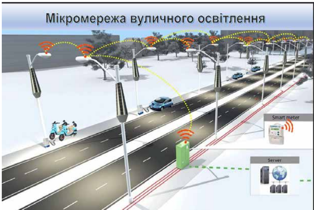
Рис. 3.6. Концепція впровадження системи мікромереж вуличного освітлення.
