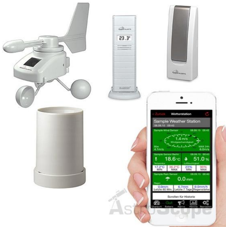
Рисунок 1.6 - Метеостанцію La Crosse MA10050
