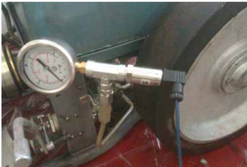
Рис. 7.12. Підключення механічного і електричного датчиків тиску
