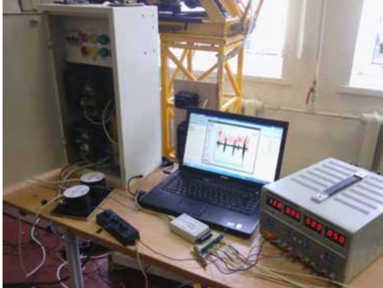
Рис. 7.9. Зовнішній вигляд модуля m-DAQ14 із електронним обладнанням для збору даних
