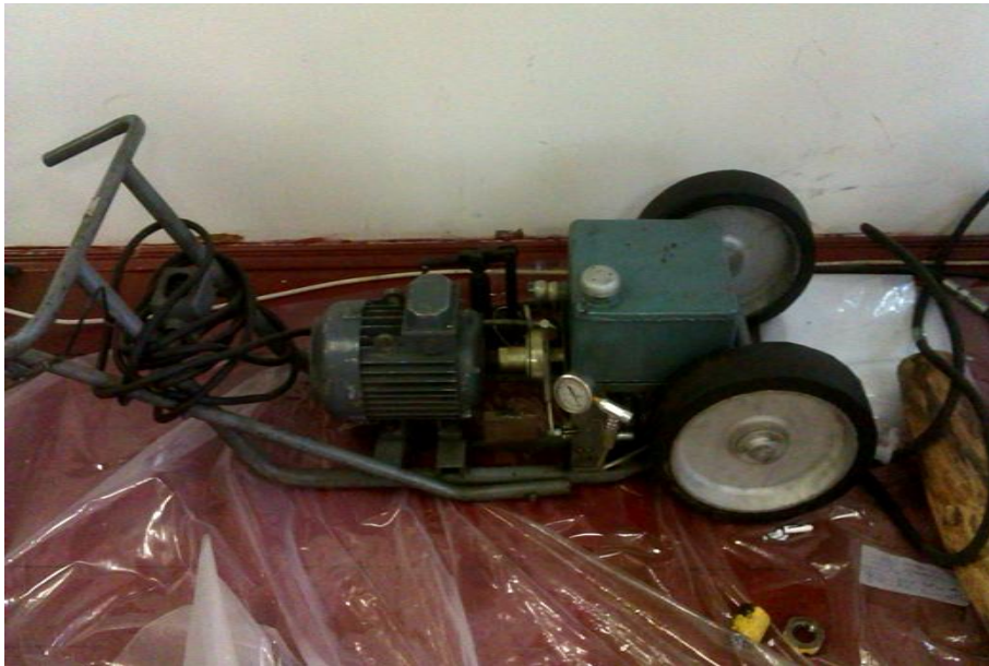
Рис. 7.2. Гідронасосна станція приводу грейферного захвата
