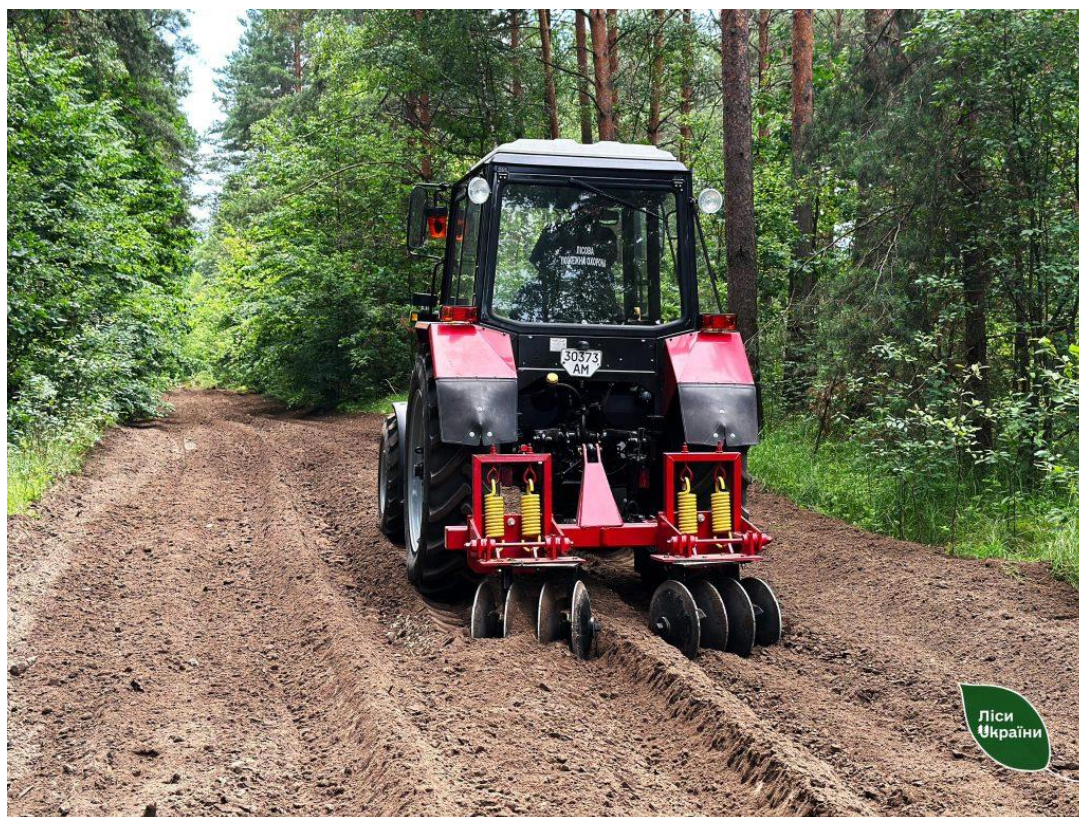
Рис 1.3. Створення мінералізованої смуги трактором МТЗ-82 [17]
