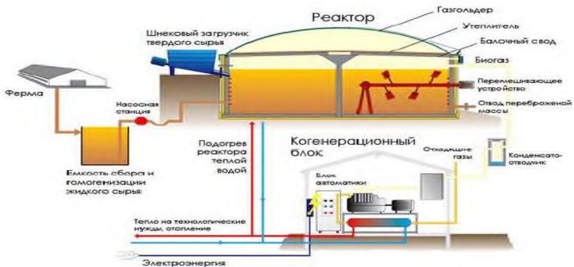
Малюнок 2.10 Схема біогазової установки
