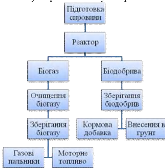
Малюнок 3.1. Схема переробки органічних відходів на біогазових установок.
