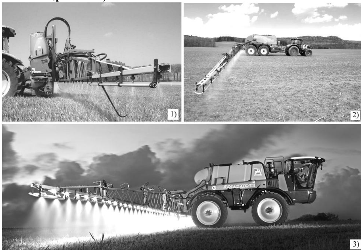
Рис. 8.5.3. Обприскувачі компанії «AMAZONE-Werke»: 1 – навісний обприскувач UF; 2 – найбільший причіпний обприскувач UX 11200, що встановив світовий рекорд; 3 – самохідний обприскувач Amazone Pantera-SX 4000 з високим кліренсом – до 1,7 м.
