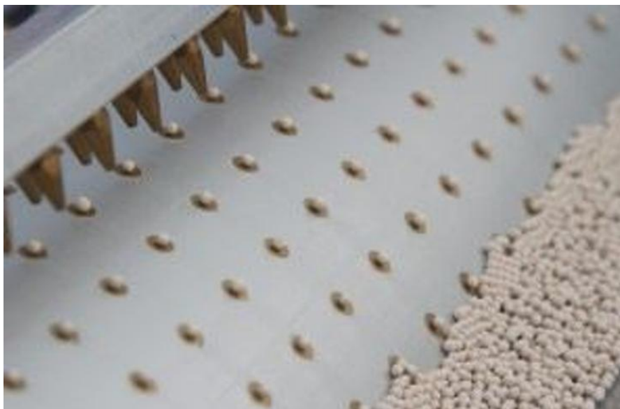
Рис. 2 Спосіб прикріплення насіння до барабану
