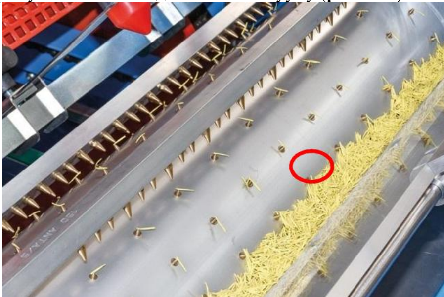
Рис. 9.1.3 Спосіб прикріплення насіння складної форми на барабан
