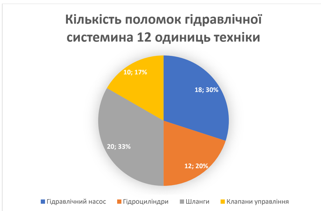
Рис.4.1 Діаграма поломок гідравлічної частини
