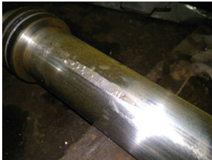
Рис.2.8 Пошкодження штока гідравлічного циліндра
