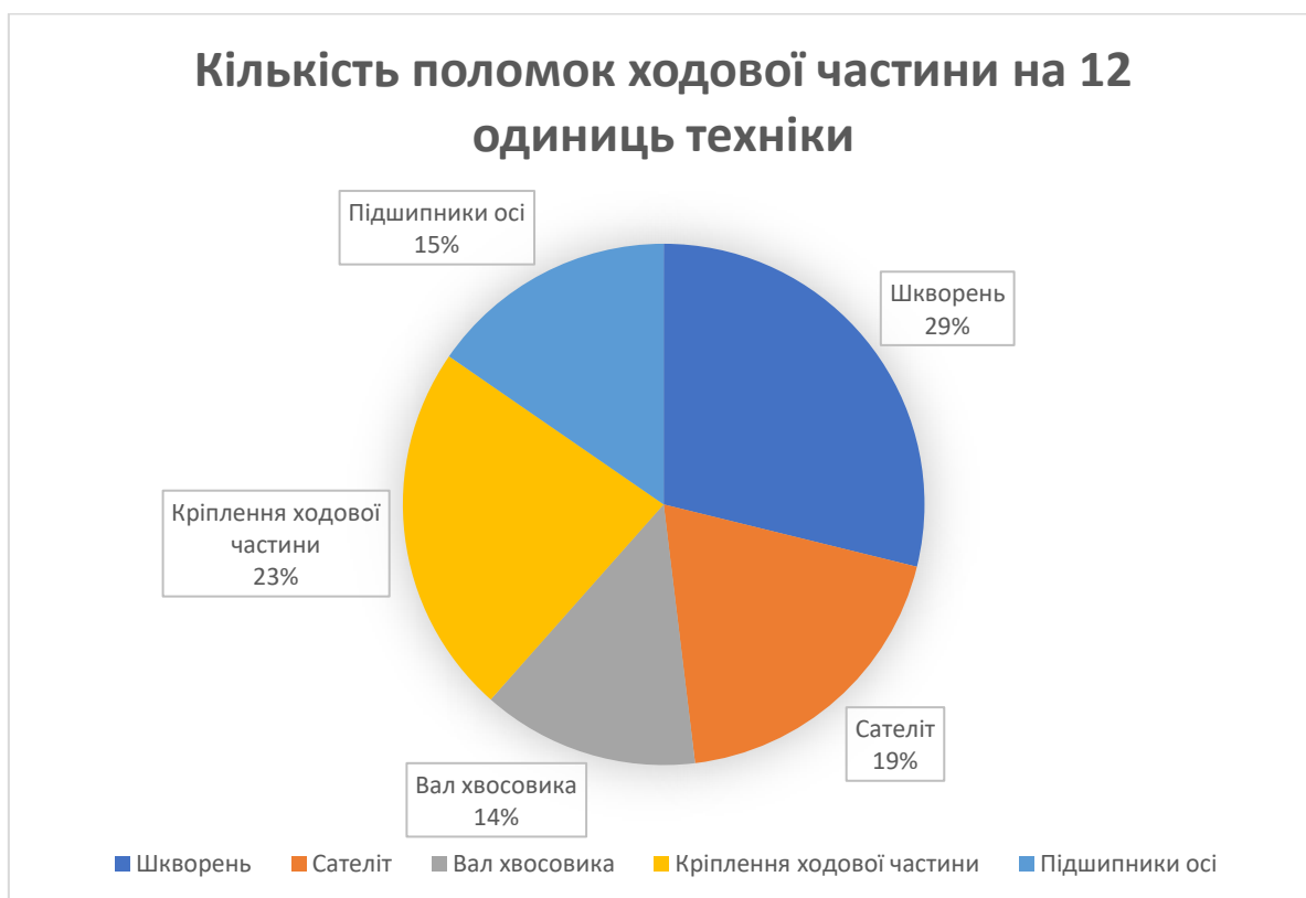
Рис. 4.2 Діаграма поломок елементів навантажувача
