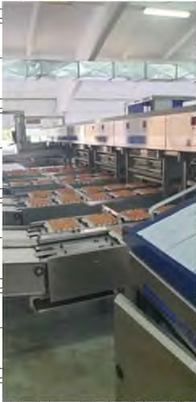
Рис.6 (б). Обладнання для сортування і пакування яєць
