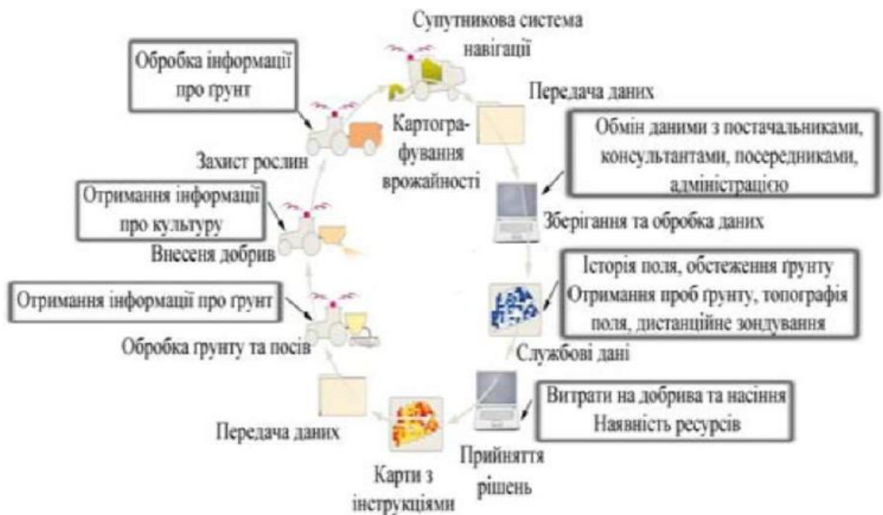
Рис. 1.15. Схема обміну інформацією в технології «розумного» землеробства на основі концепції IoT
