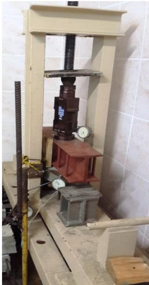
Рис. 8 Експериментальна установка для випробування зразків на вдавлювання арматури в бетон [42]
