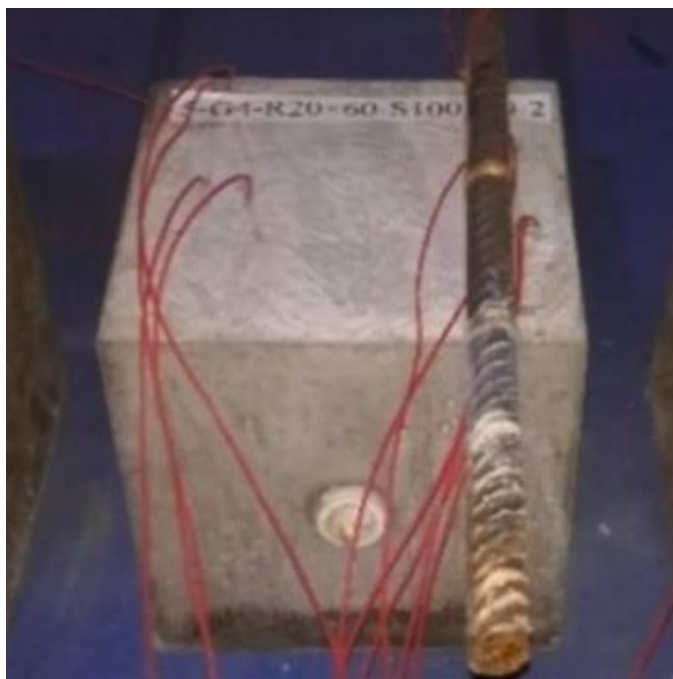
Рис. 14 Схема руйнування типу висмикування [49]
