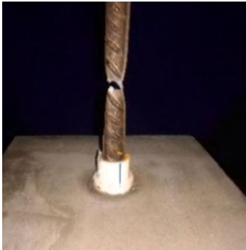
Рис. 17 Схема руйнування арматури від розтягування [49]
