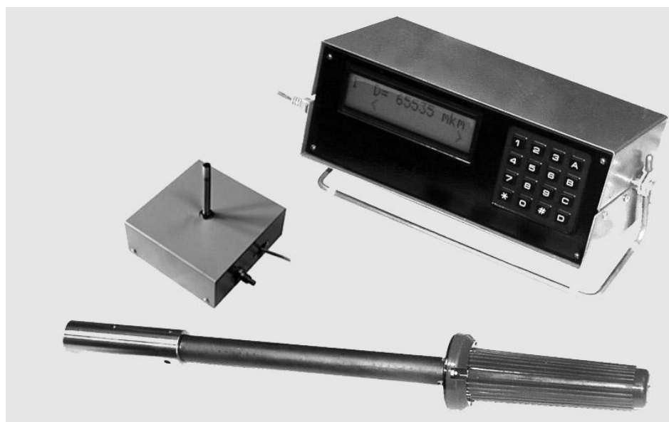
Фото 3.7. Забір отворів корпусу розподільника
