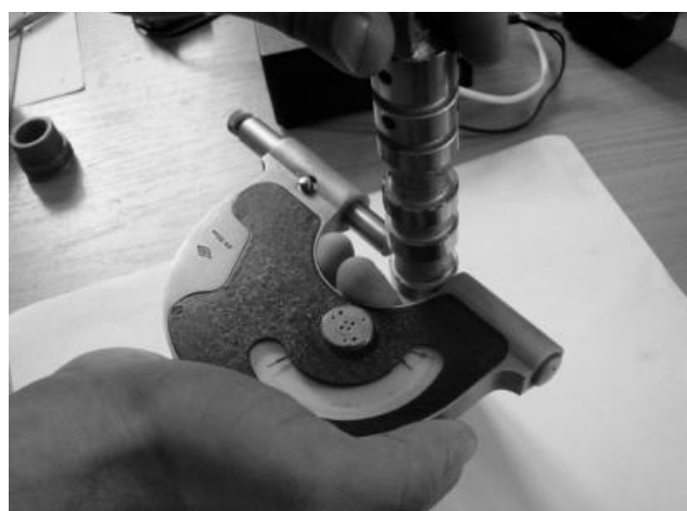
Рис.3.5. Схема заміру поясків золотника
