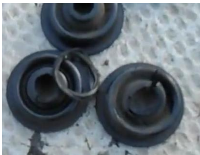
1.11. Знос та руйнування гумових ущільнень
