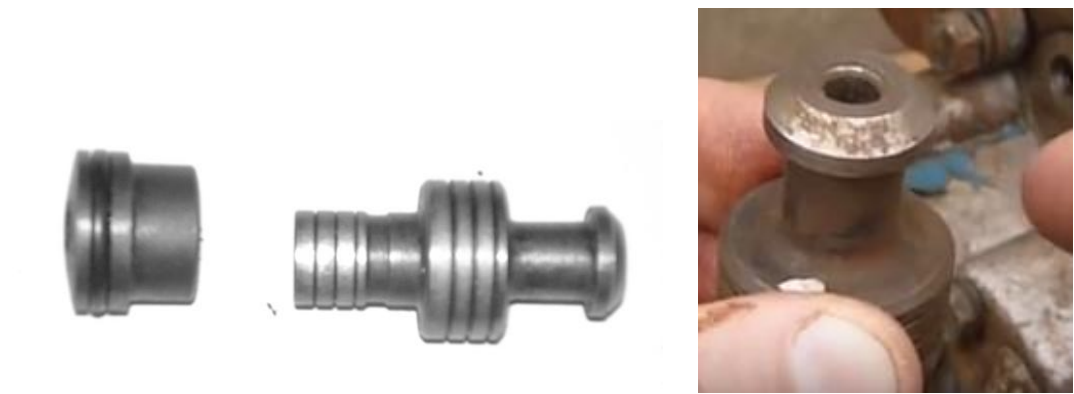
Рис. 1.9. знос та корозія перепускного клапана
