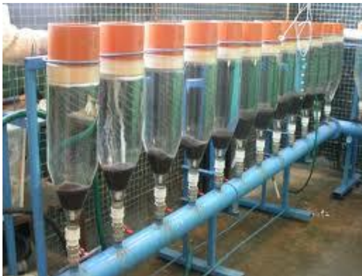
Рис. 3.6 Інкубування ікри осетрових в апаратах Вейса
