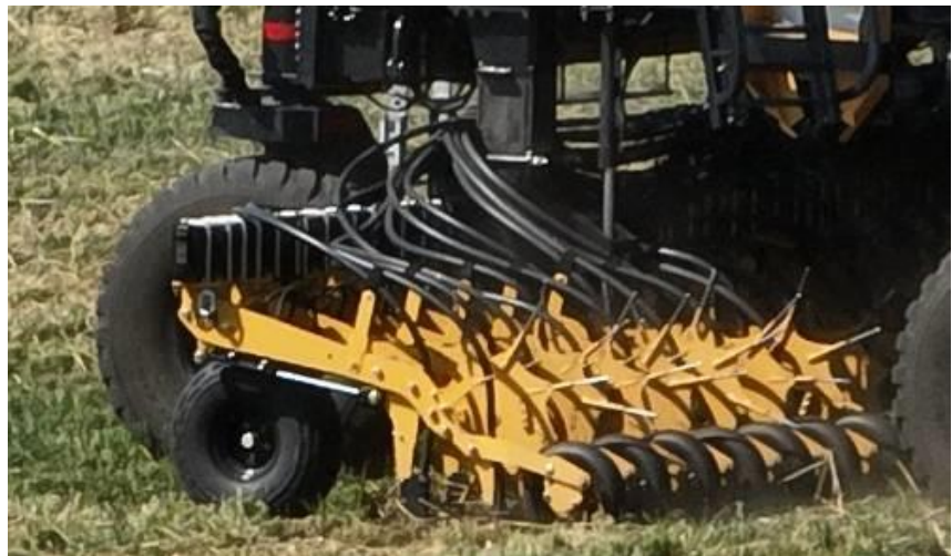
Рис. 2. Серійні виконавчі механізми зернової сівалки Seed Master в агрегаті з автономним роботом DOT.
