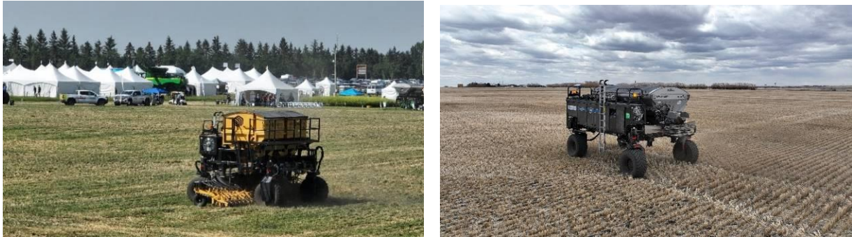
Рис. 1. Автономні платформи DOT а) та OMNI б) на виконанні відповідно, сівби зернових та внесенні мінеральних добрив.
